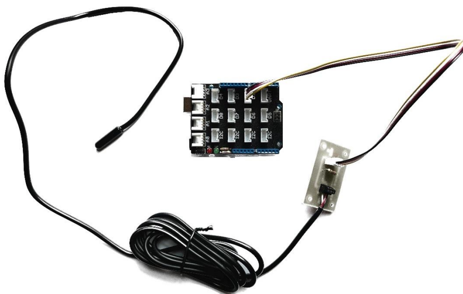
Figura 18 – Il sensore di temperatura corporea collegato alla piattaforma di prototipazione Arduino.
