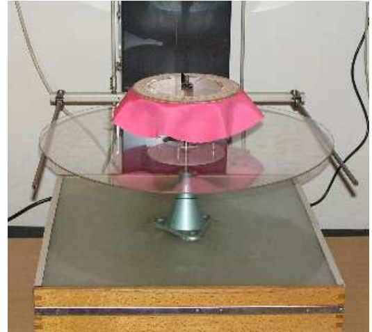
Obr. č. 19: Textília uvedená do splývajúceho stavu, v ktorom sa prevádza meranie DC (dolná poloha podporného disku).
