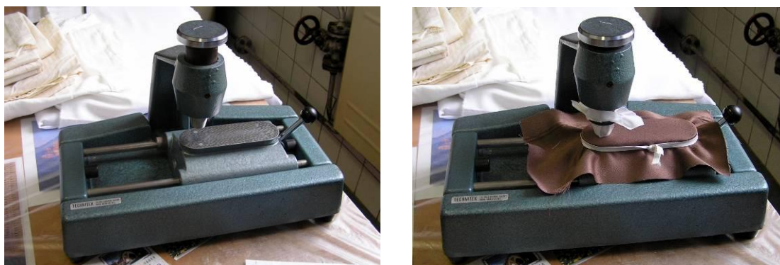
Obr. 8: Vlevo přístroj pro testování otěru, vpravo vlastní testování
