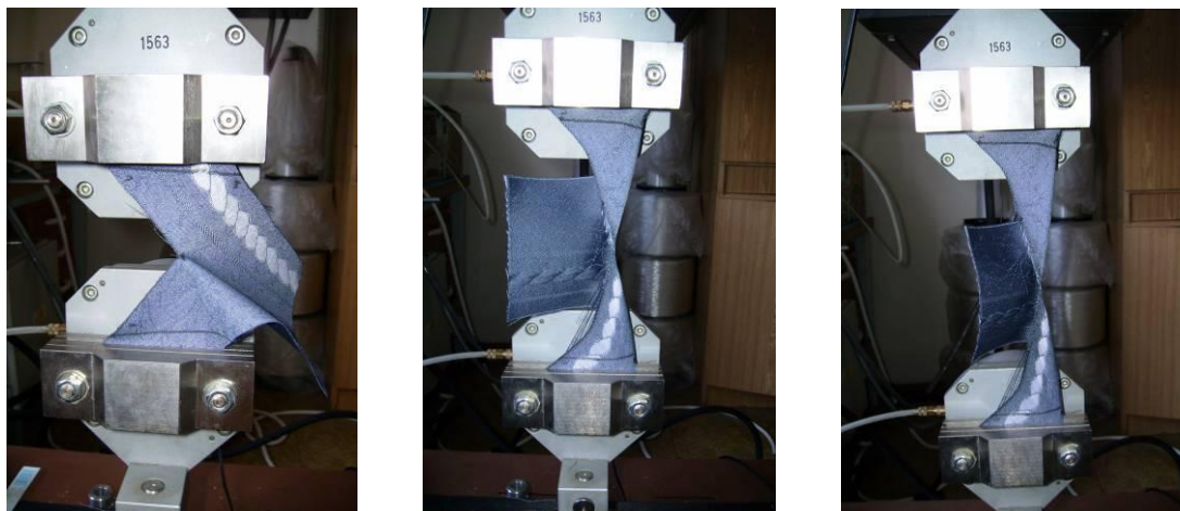
Obr. 16: Průběh zkoušky při testování dotržení
