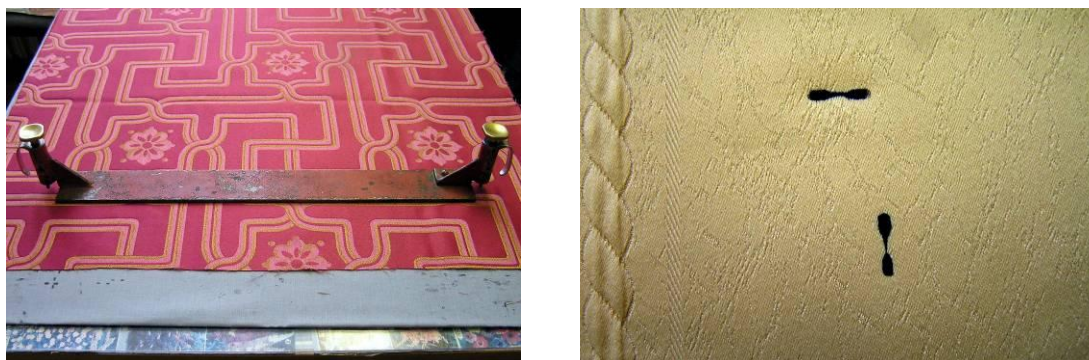
Obr. 10: Vpravo raznice se vzorkem, vlevo již označovaný vzorek
