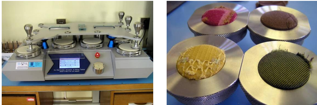
Obr. 19: Vpravo přístroj Martindale, vlevo zkoušené vzorky
