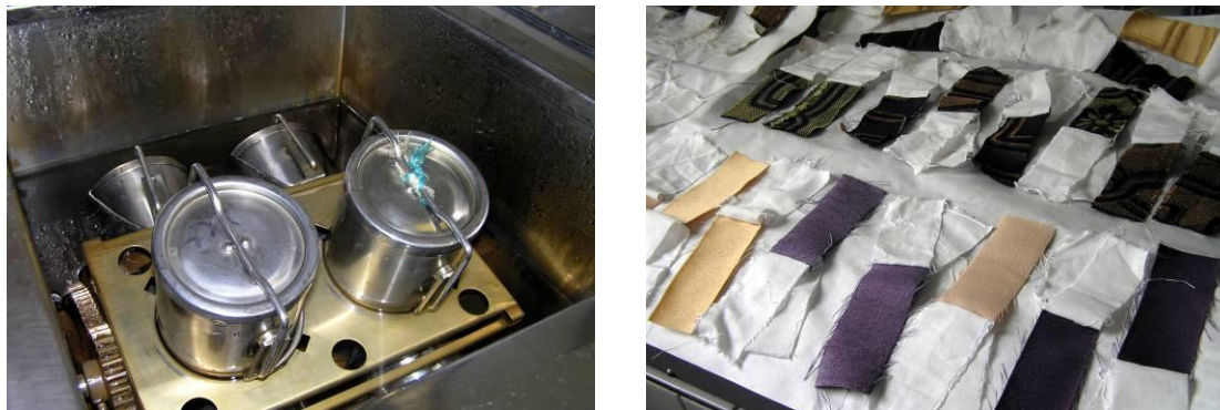
Obr. 7: Vlevo korozivzorné patrony v přístroji Linitest, vpravo sušení vzorků
