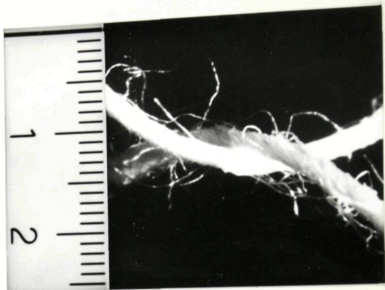
obr. 36 a (zploštění přízí při F_k = 1 \text{ mN} )
