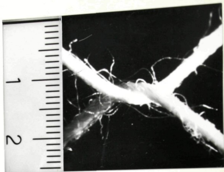
obr. 36 c (zploštění přízí při F_k = 10 \text{ mN} )
