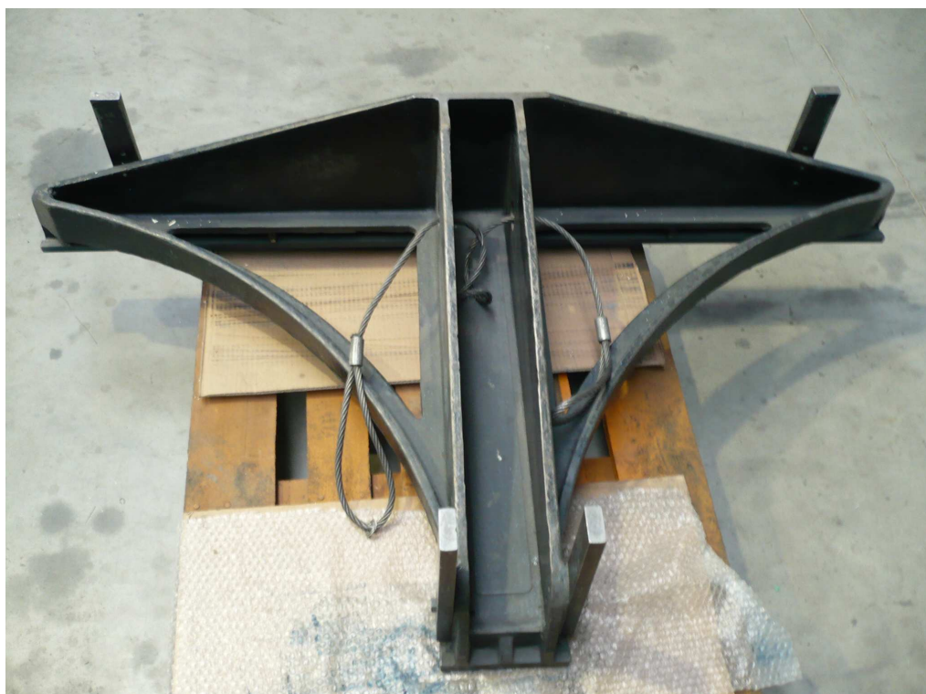
Obr. č. 12.: Přípravek pro měření souběžnosti čelních dosedacích ploch stojanů a souběžnosti vodicích ploch pracovního stolu
