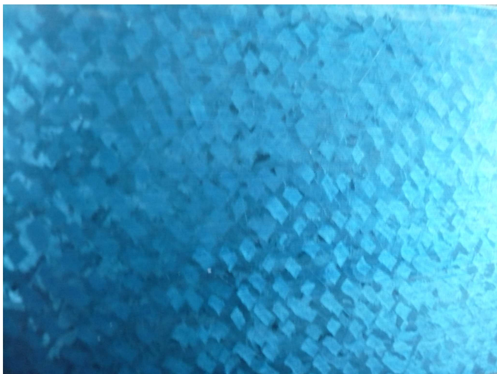
Obr. č. 6.: Vzor povrchové úpravy vodicích ploch po zaškrabání
