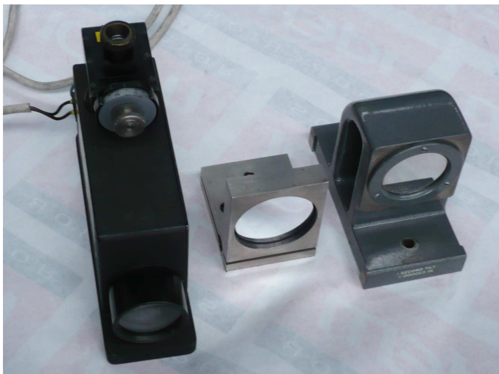
Obr. č. 8.: Sestava měřicího zařízení: Autokolimátor
