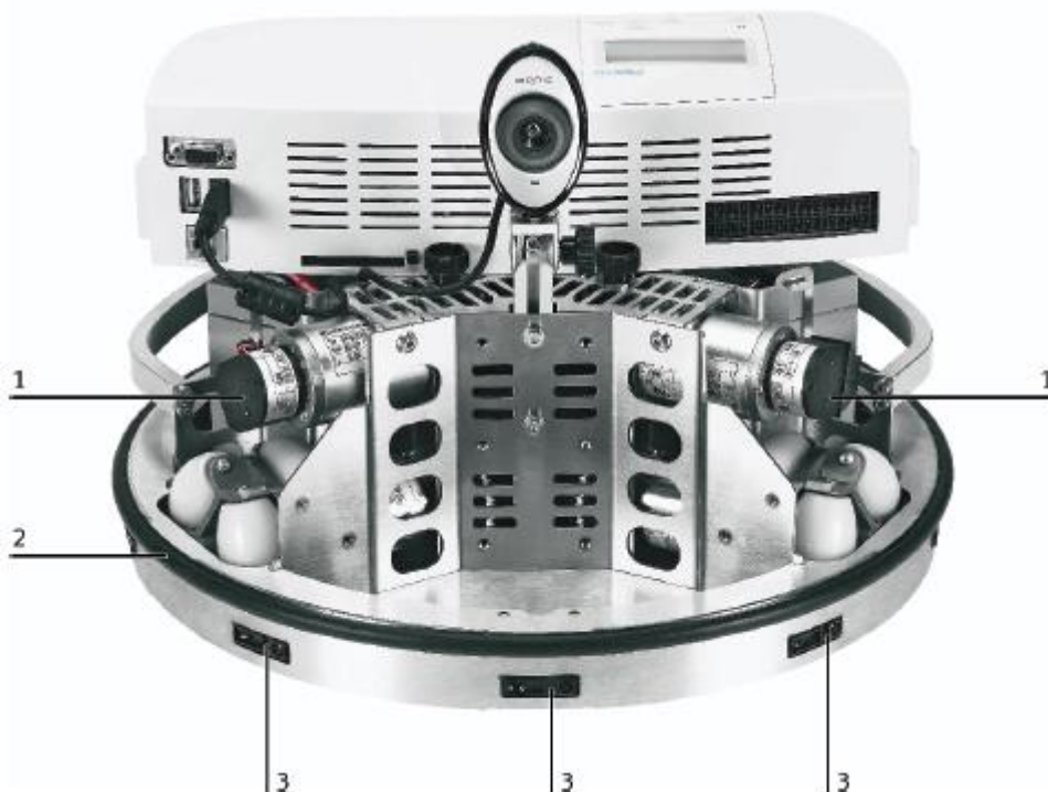
Obr. 4: Inkrementální snímač (1), Anti-kolizní snímač (2), Infračervený snímač (3) [2]
