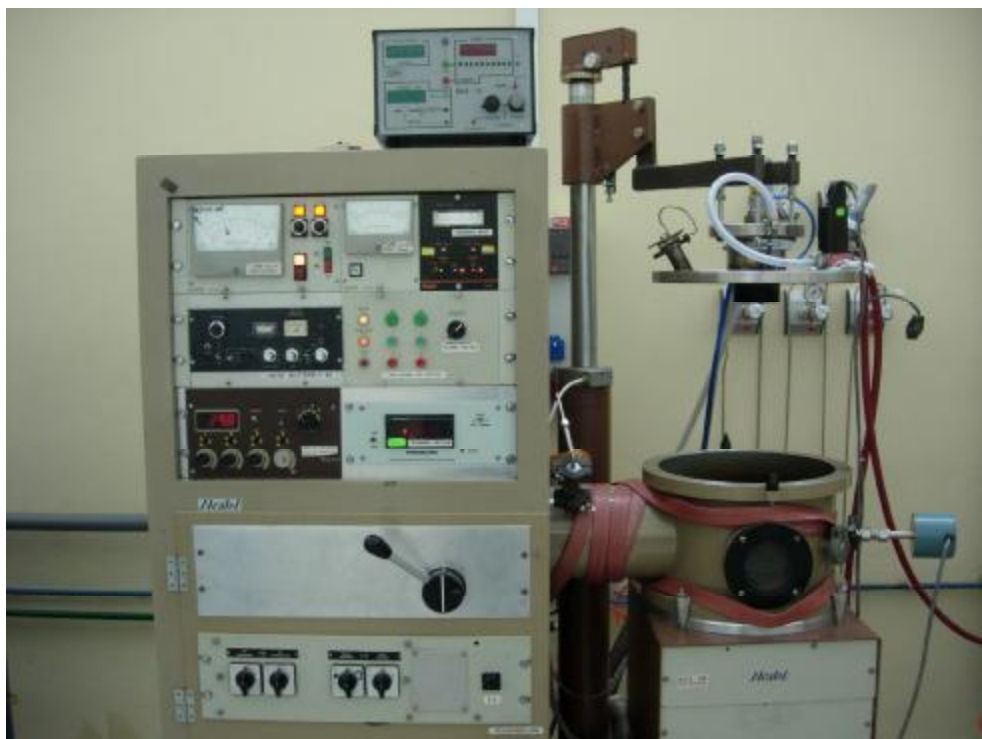
Obr. 3.10: Powlakovací zařízení pro kombinaci metod PVD + CVD
