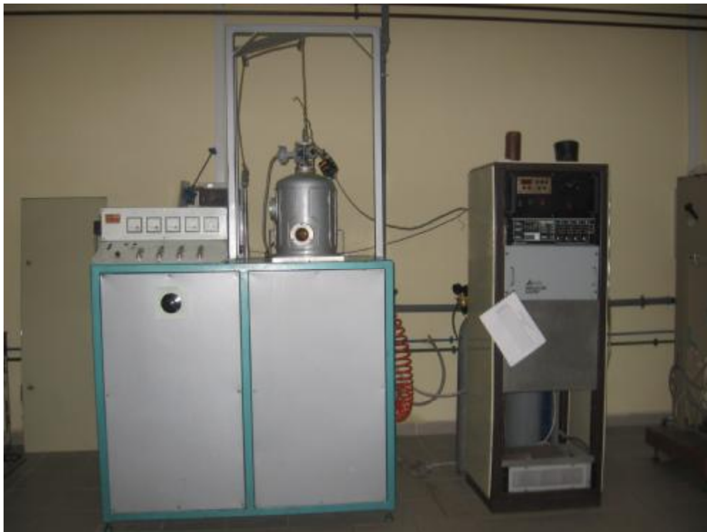
Obr. 3.5: Povlakovací zařízení pro metodu RW [9]
