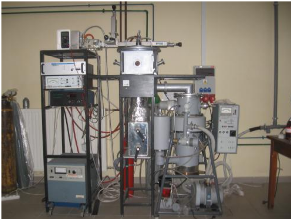
Obr. 3.9: Povlakovací zařízení pro metodu MV/RF [9]
