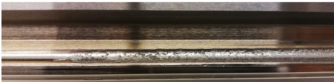
Obr. 4.5 Poškození vodícího profilu – pitting
