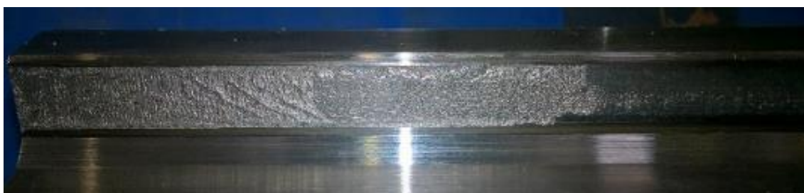
Obr. 4.6 Poškození vodícího profilu – pitting a abrazivní poškození
