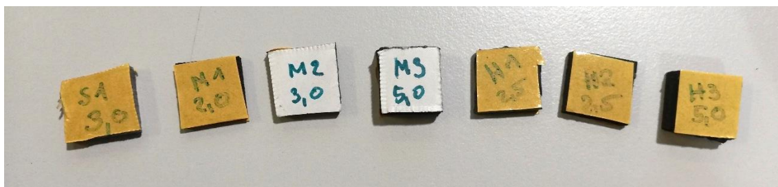
Obr. 6.18 Zkušební vzorky pryží s různou tvrdostí a tloušťkou pro pružné uložení snímače zrychlení vibrací. Tvrdost: S – měkká; M – středně tvrdá; H – tvrdá. Tloušťka: 2mm; 2,5mm; 3mm; 3,5mm a 5mm
