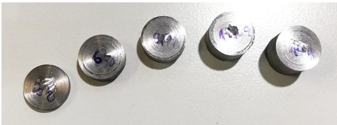
Obr. 6.19 Zkušební vzorky přídavných závaží pro pružné uložení snímače zrychlení vibrací. Hmotnosti: 3g; 6g; 9,5g; 12,5g a 14g
