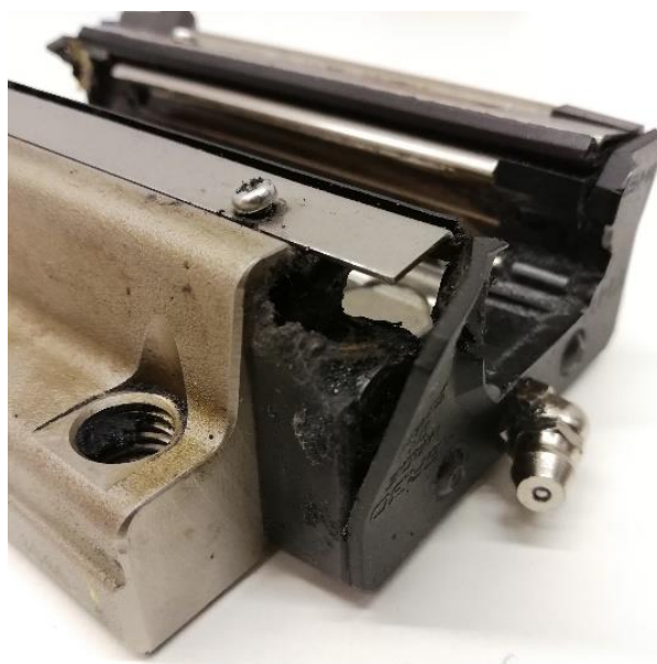
Obr. 4.7 Destrukce součástí tělesa při progresi únavového poškození
