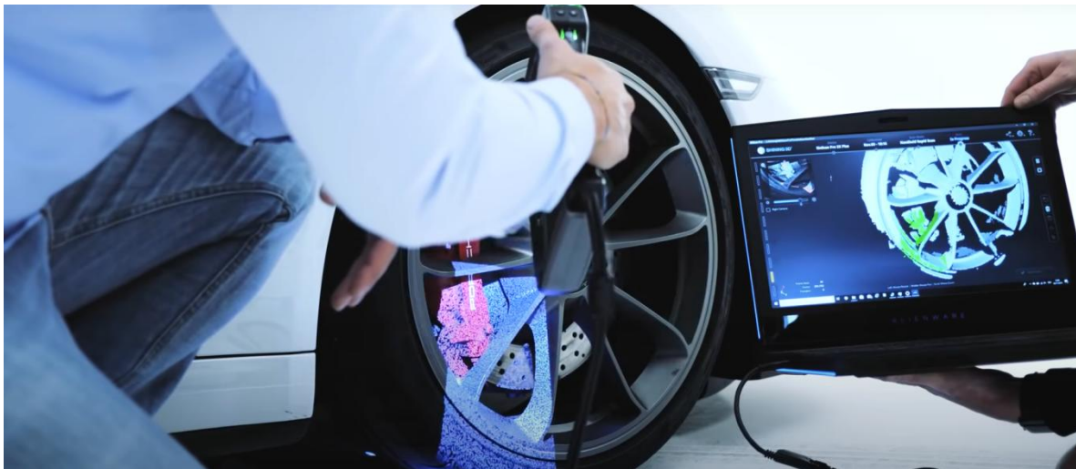
Obrázek 9 Ukázka použití skeneru EinScan [13]
