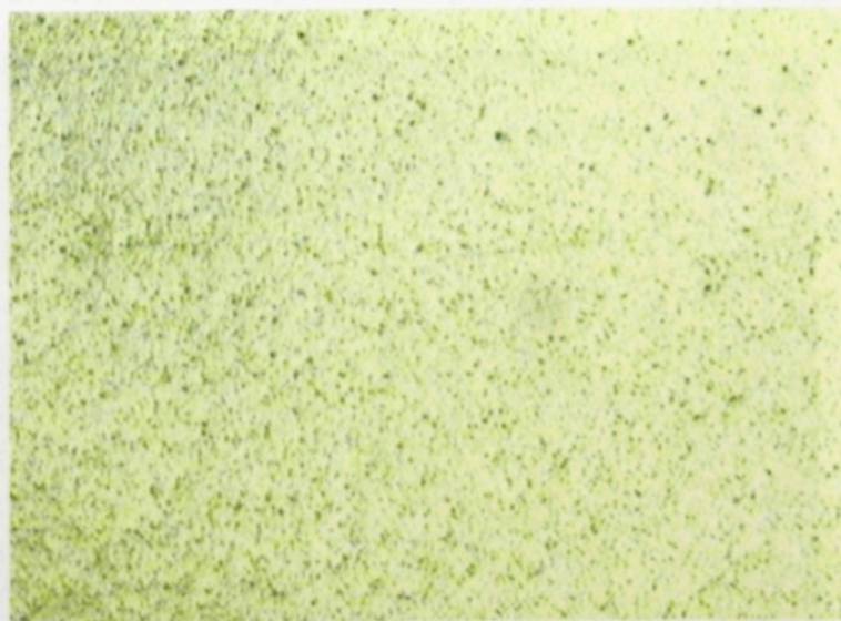
Obr. 6 Výchozí nezkorodovaný vzorek 2A17 ZrN_{60}
