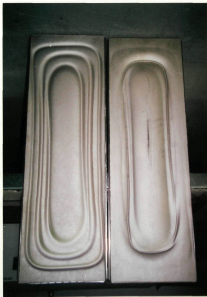
Obr.21 Target pro řízené ARC napařování x ARC/ Magnetron napařování
