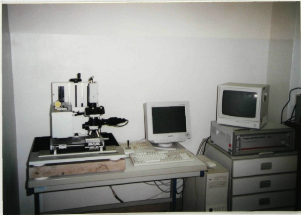
Obr. 29 Měřicí zařízení FISCHERSCOPE H100
