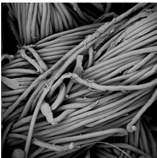
Obr. č. 30 - Snímek polyesteru s nanesenou vrstvou chitosanu o koncentraci 8 \text{ mg} \cdot \text{g}^{-1} podle postupu 1.
