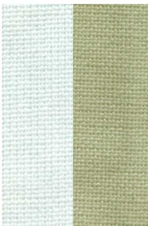
Obr. č. 27 - Vzorek připravený podle kapitoly 3.5.1.3. Barvení filmů na textiliích. Obarvený film z chitosanu reaktivním barvivem Ostazinová žluť H5G (6% z hmotnosti polysacharidu).
