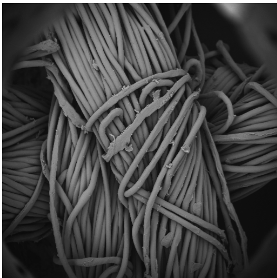
Obr. č. 34 - Snímek polyesteru s nanesenou vrstvou chitosanu o koncentraci 0,0008 \text{ mg}\cdot\text{g}^{-1} podle postupu 1.
