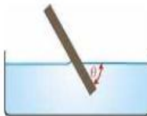
Obr. 4: Meranie \theta na naklonenej doske [9].
