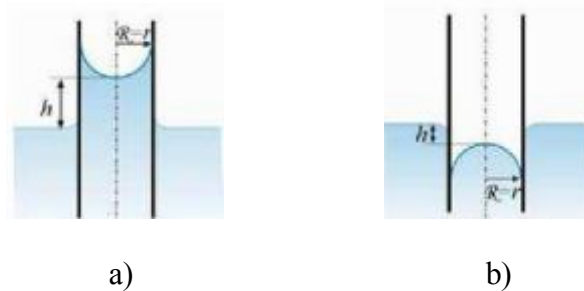
Obr. 10: Kapilárna elevácia (a) a depresia (b) [9].
