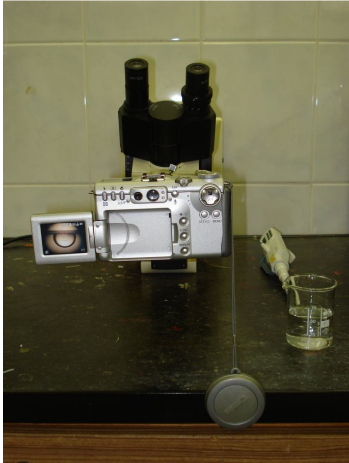
Obr. 27: Snímok zhotovený pri meraní kontaktného uhlu optickou metódou.
