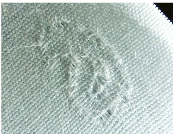
Obrázek 26: Narušení vazby v žakáru (Regina 181)
