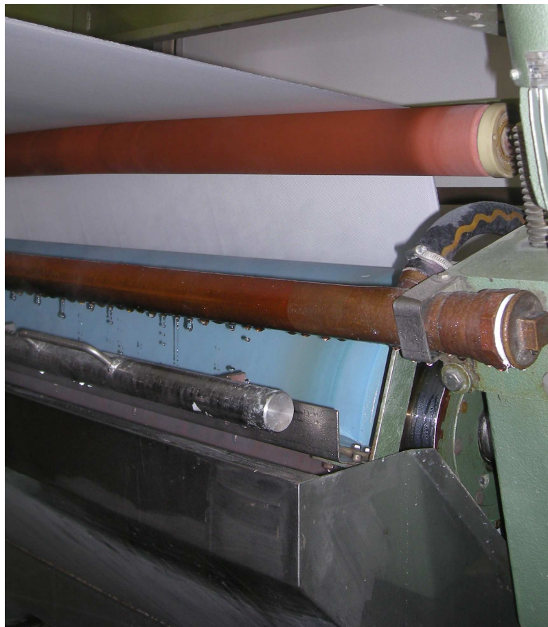
Příloha 23: Proces sanforizace (pohled na ochlazovací část bubnů s pryžovým povrchem)
