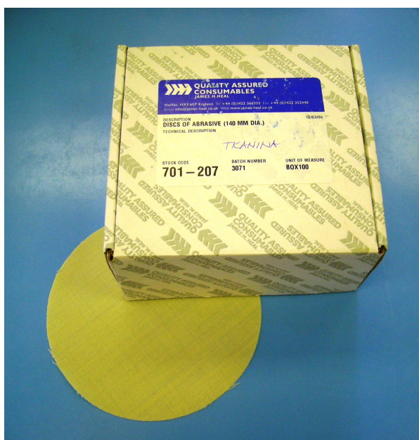
Obrázek 16: Normovaná oděrací textilie
