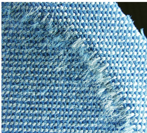
Obrázek 27: Narušení keprové vazby v hraně (Trial 1)
