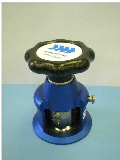
Obrázek 13: Řezací nástroj s žiletkou, d je 38 mm
