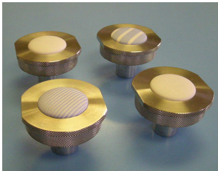
Obrázek 14: Upnuté vzorky materiálu
