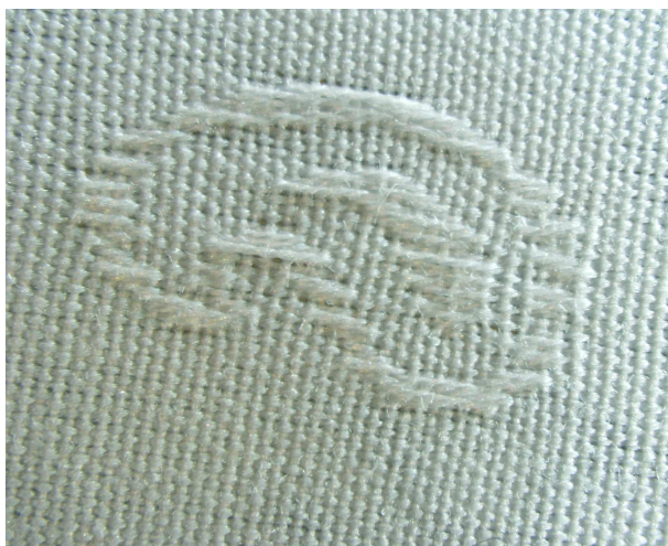
Obrázek 25: Košilová tkanina Regina 181 před měřením zkoušky odolnosti v oděru
