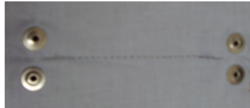
Obrázek 37 - nitinolový drát aplikován na oděvní materiál krycím stehem a vodivé dráhy ukončené pomocí kovových druků a aplikací měděné fólie
