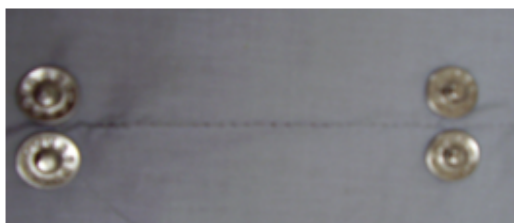
Obrázek 37 - nitinolový drát aplikován na oděvní materiál krycím stehem a vodivé dráhy ukončené pomocí kovových druků a aplikací měděné fólie
