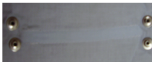
Obrázek 41 - textilní stuha RIBBON aplikována na oděvní materiál a vodivé dráhy ukončené pomocí kovových druků 1. způsob
