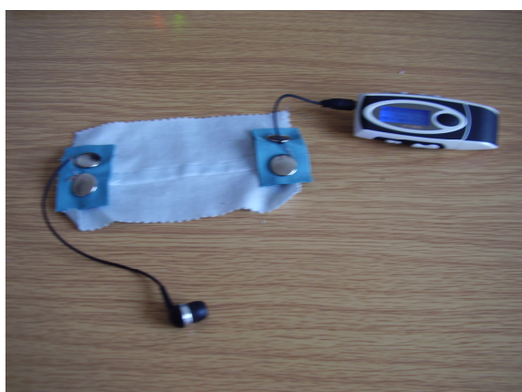
Obrázek 52 - spojení vodivé dráhy (stuhý RIBBON) s konektorem (do kterého je napojen MP3 přehrávač) na jedné straně a na druhé straně se sluchátkem pomocí odejíratelných kovových druků
