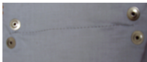
Obrázek 38 - nitinolový drát aplikován na oděvní materiál krycím stehem a vodivé dráhy ukončené pomocí kovových druků
