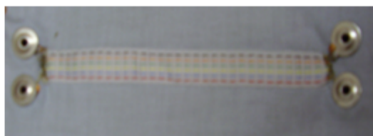
Obrázek 39 - textilní stuha RIBBON aplikována na oděvní materiál a vodivé dráhy ukončené pomocí kovových druků 2. způsob s měděnou fólií
