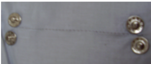
Obrázek 38 - nitinolový drát aplikován na oděvní materiál krycím stehem a vodivé dráhy ukončené pomocí kovových druků
