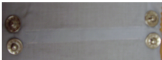
Obrázek 40 - textilní stuha RIBBON aplikována na oděvní materiál a vodivé dráhy ukončené pomocí kovových druků 2. způsob
