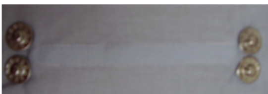
Obrázek 39 - textilní stuha RIBBON aplikována na oděvní materiál a vodivé dráhy ukončené pomocí kovových druků 2. způsob s měděnou fólií
