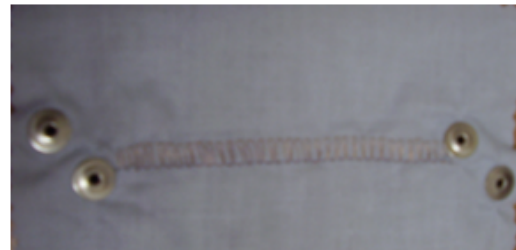
Obrázek 36 - měděný drát aplikován na oděvní materiál krycím stehem a vodivé dráhy ukončené pomocí kovových druků
