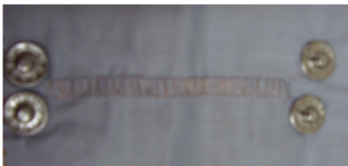
Obrázek 35 - měděný drát aplikován na oděvní materiál krycím stehem a vodivé dráhy ukončené pomocí kovových druků s aplikací měděné fólie
