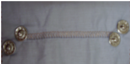
Obrázek 36 - měděný drát aplikován na oděvní materiál krycím stehem a vodivé dráhy ukončené pomocí kovových druků
