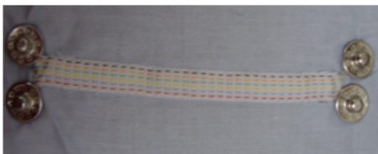
Obrázek 41 - textilní stuha RIBBON aplikována na oděvní materiál a vodivé dráhy ukončené pomocí kovových druků 1. způsob
