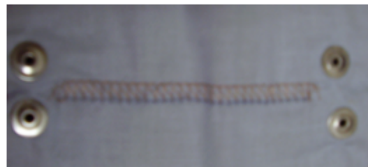
Obrázek 35 - měděný drát aplikován na oděvní materiál krycím stehem a vodivé dráhy ukončené pomocí kovových druků s aplikací měděné fólie
