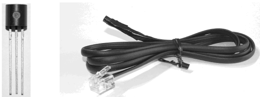
Obr. 5.: Součástka DS18B20 a výsledný zhotovený senzor teploty
