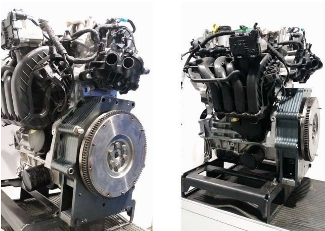
Obrázek 18 Pohled na motor s namontovaným měřícím mezičlenem (vlastní zpracování)
