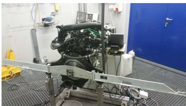
Obrázek 29 Pohled na kalibrační ramena (vlastní zpracování)
