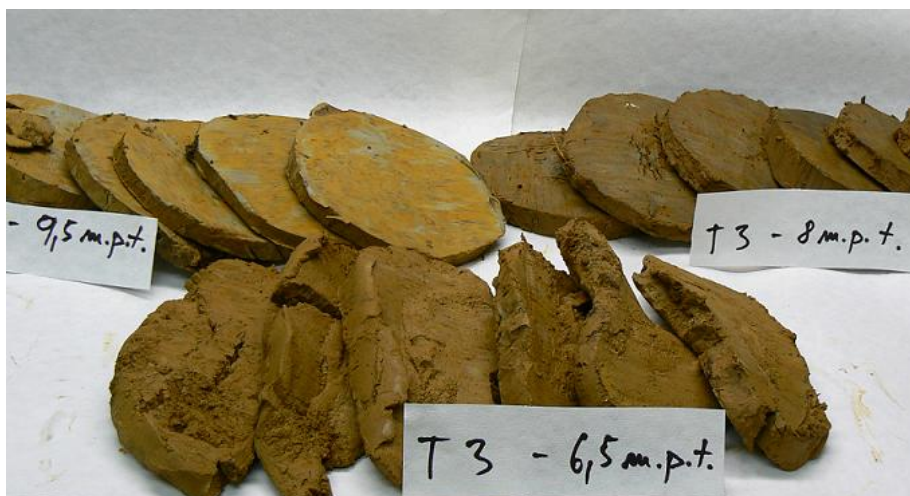
Obr. 5.5: Příprava vsázky – koláče z různých hloubkových úrovní vrtného jádra.
