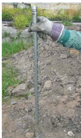
Obr. 3.2: Souprava EcoProbe pro metodu přímého vtlačení „direct-push“ (vlevo), detail zarážené sondy (vpravo). Foto z aplikace v Hořicích.
