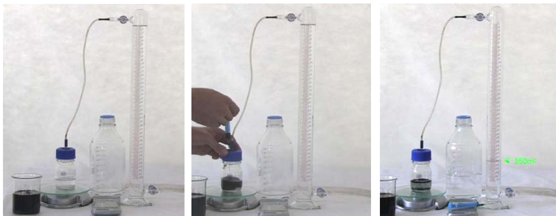
Obr. 4.3: Postup práce s analyzátozem nanoželeza, výrobce NANO IRON, s.r.o. (zdroj [29]).
