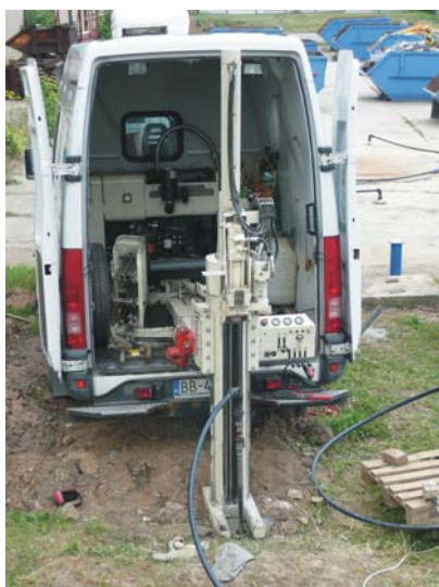
Obr. 3.2: Souprava EcoProbe pro metodu přímého vtlačení „direct-push“ (vlevo), detail zarážené sondy (vpravo). Foto z aplikace v Hořicích.
