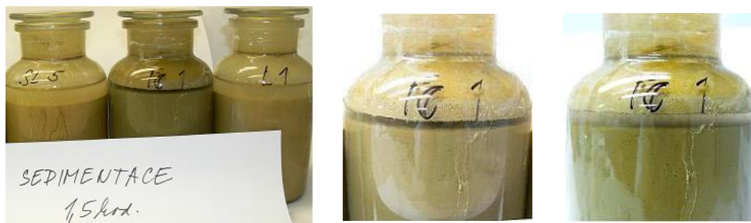
Obr. 5.7: Sedimentace vzorků – všechny vzorky po 90 min sedimentace (vlevo), vzorek s nanoželezem po 90 (uprostřed) a 180 hodinách (vpravo) sedimentace.
