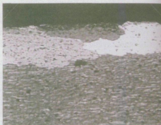
Obr.7 Povrchová hrubozrnná rekrystalizovaná vrstva v příčném řezu u slitiny AlCuMgPb Zv. 100x
