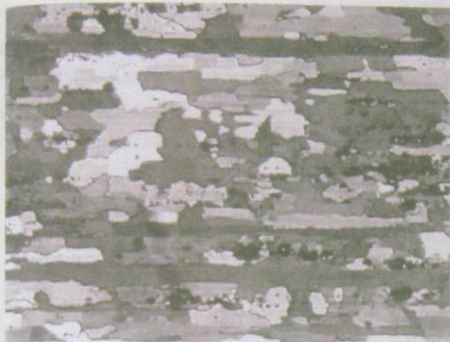
Obr.4 Částečně rekrystalizovaná struktura u slitiny AlZnMgCu1.5 Zv. 100x
