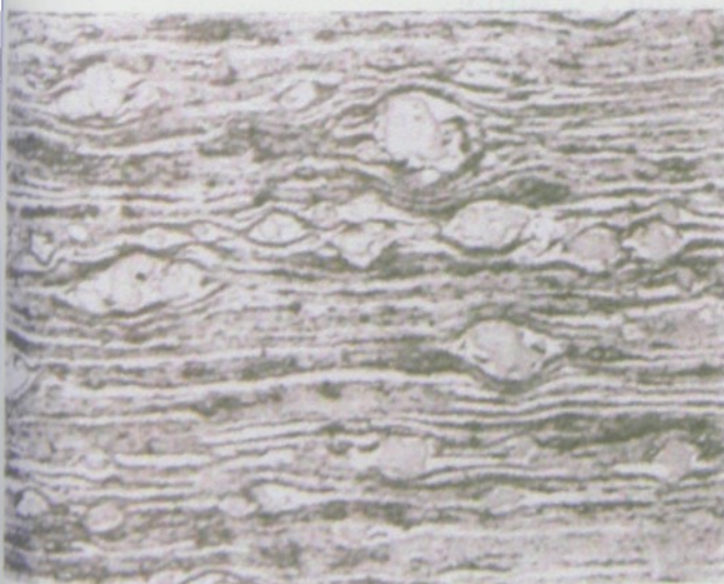
Obr.9 Intermetalické fáze TiAl_3 u slitiny AlTi_5B_1 po leptání v roztoku KMnO_4 + NaOH po dobu 15 sekund Zv. 740x
