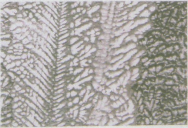
Obr.16 Barevné leptání peříčkovitého zrna u slitiny AlMg5 na zviditelnění hlavních a vedlejších krystalizačních směru Zv. 150x
