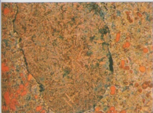
OBR. 10. Struktura heterogenního tuhnutí siluminu uvnitř a mimo oxidickou blánu. Barevné leptání s pozorováním ve světlém poli. Zvětšeno 150 x.
