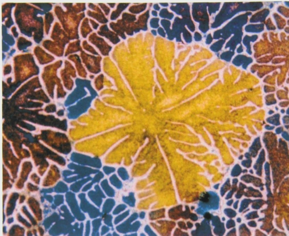
Obr. 20 Struktura slitiny AlCu4MgMnPb po homogenizaci 11 hodin. Kvalitní homogenizace je charakterizovaná rovnoměrným zbarvením v rámci jednotlivých dendritických buněk. Zv. 100x
