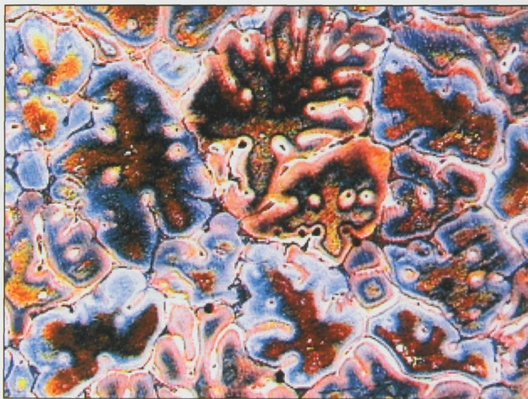
Obr.17 Struktura slitiny AlMgSiPbBi před homogenizací. Zv. 300x
