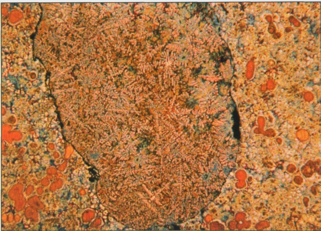
Obr. 28 Struktura podeutektického siluminu s výskytem velké oxidické blány Zv. 200x
