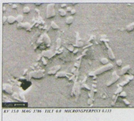
Kostrovité útvary světlého modrého zbarvení intermetalických sloučenin po barevném leptání . Zv. 500x
