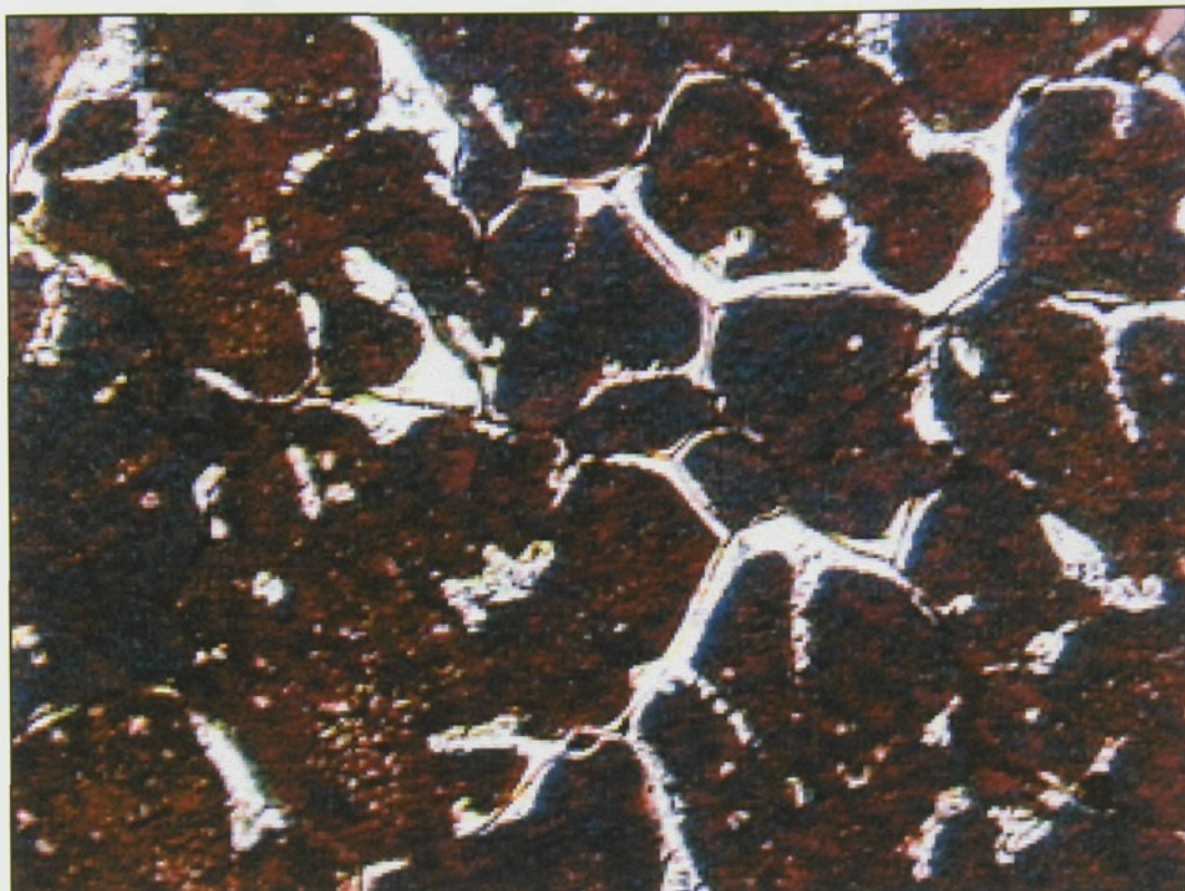
Obr.18 Struktura slitiny AlMgSiPbBi po homogenizaci 12 hodin. Zv. 300x
