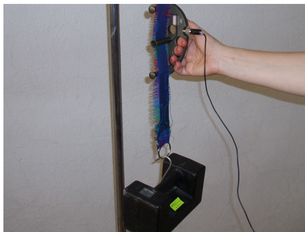
Obr.28 Držení snímače při kalibraci
