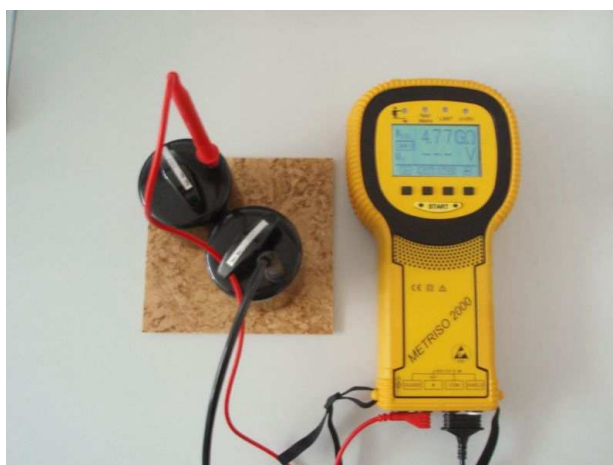
Obr. 37 Měření alternativní náhrady presovací gumičky
