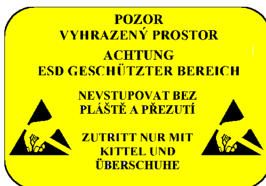
Obr. 7 Varovný nápis vně vyhrazeného prostoru
