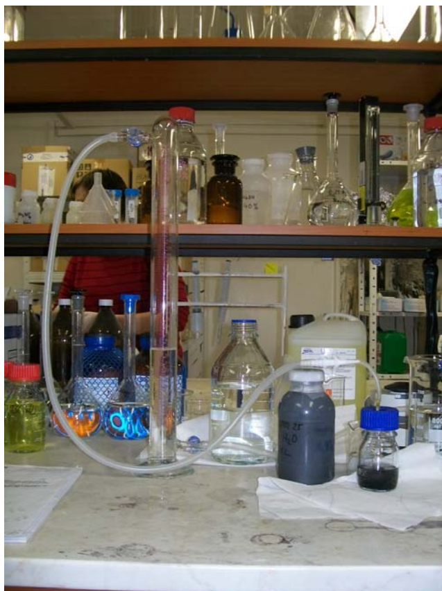
Obr. 7 Laboratorní sada pro určení obsahu elementárního nanoželeza od firmy NANO IRON s.r.o.
