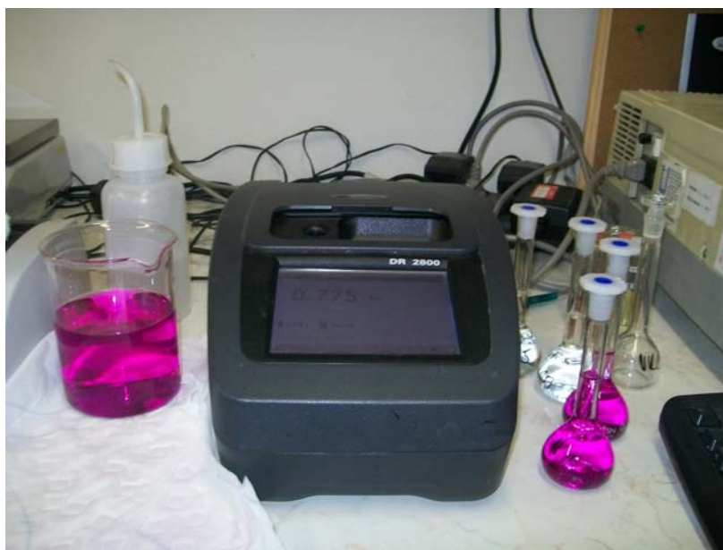
Obr. 8 Fotometr Hach Lange DR 2800, na kterém byla měřena koncentrace \text{Cr}^{6+} veškerých vzorků.
