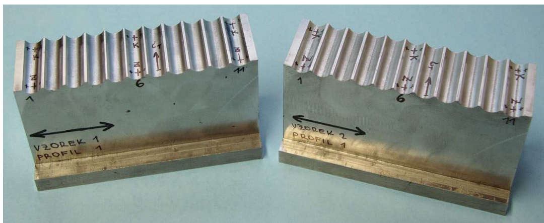
Obr. 7.35 Zkušební vzorky: 1 – frézovaný kulovou monolitní frézou, 2 – frézovaný kulovou frézou s vyměnitelnými břitovými destičkami (VBD)
