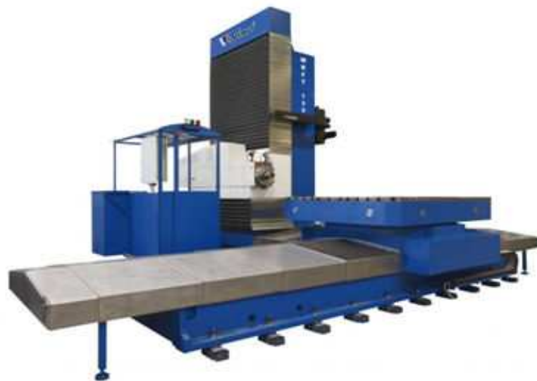
Obr. 7.58 Horizontální vyvrtávačka, pro jejíž vedení byla prováděna analýza parametrů integrity povrchu
