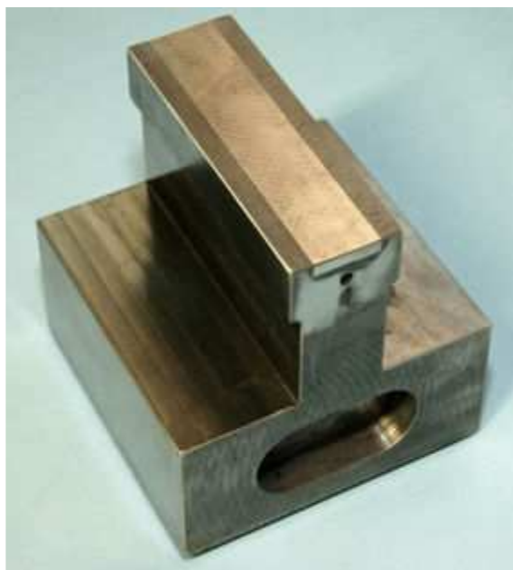
Obr. 7.56 Segment z vedení obráběcího stroje z jehož horní části byl ve všech případech vyříznut zkušební vzorek (obr. 7.57)
