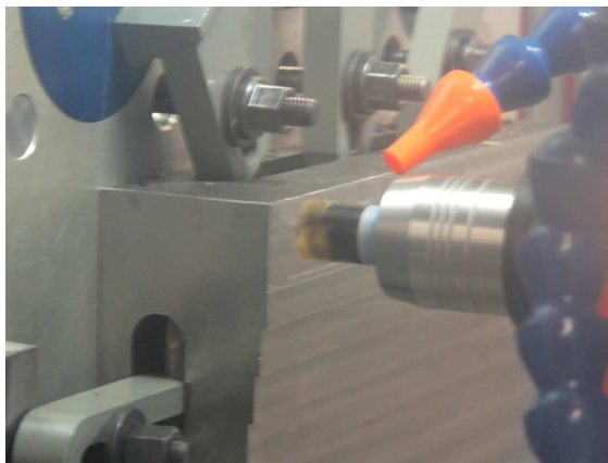
Obr.7.22 Ranque – Hilschova vírová trubice chlazený stlačený vzduch + 4°C (Vzorek V) mražený stlačený vzduch – 8°C (Vzorek VI)
