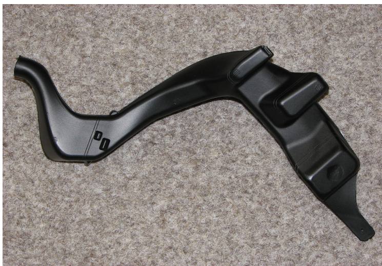
Obr. 3. 4. 2. 1: vzduchové vedení PSA A7 Foot Room Front levý RHD
