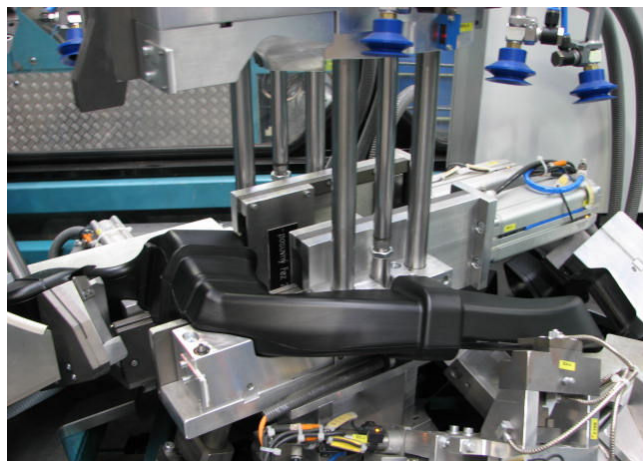
Obr. 2. 3. 2. 12: správné založení dílu v opracovacím zařízení
