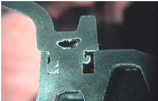
Obr 2.3.: Ukázka lunkru na výrobku /3/
