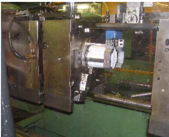
Obr. 3.5.: Otevřená vstřikovací forma s tělesem palivového modulu
