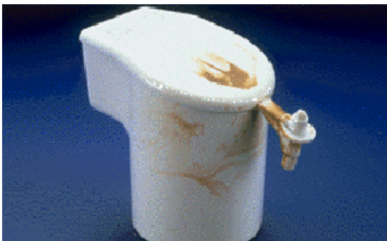
Obr. 2.2.: Výrobek se šlírovitostí /4/
