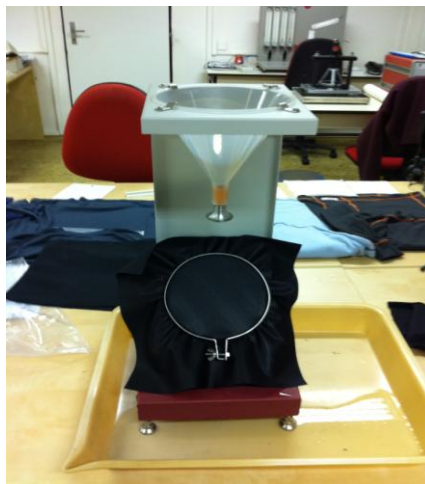
Obr. 1A Povrchové smáčení dle normy ČSN EN 24920.
