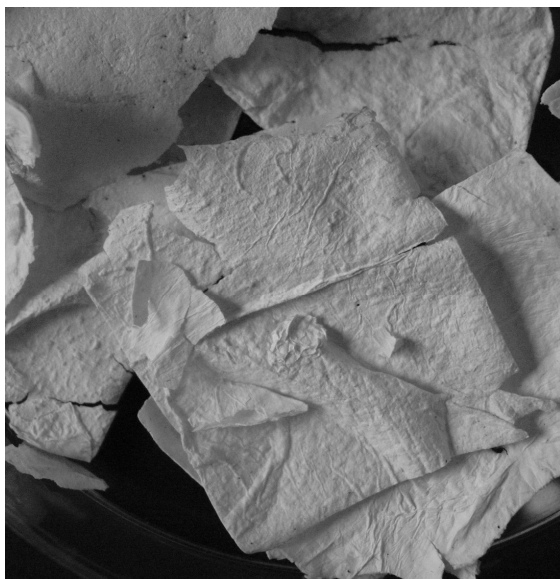
Obrázek 94 – Nanovláknenná vrstva ze solu J18, poloprovozní zvlákňování, smočena v solu SiAg7. Digitální fotoaparát, skutečná velikost.
