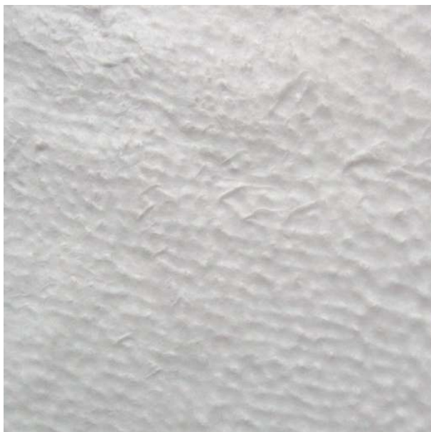
Obrázek 85 - Nanovláknenná vrstva ze solu J18, poloprovozní zvlákňování. Digitální fotoaparát, skutečná velikost.
