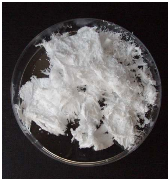
Obrázek 84 - Nanovláknenná vrstva ze solu J11/II, poloprovozní zvlákňování, vzhled po oddělení od podkladové textilie.
