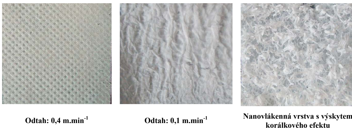
Obrázek 77 - Vzhled nanovláknenné vrstvy ze solu J11/II, poloprovozní zvlákňování při rozdílných výrobních podmínkách. Digitální fotoaparát, skutečná velikost.
