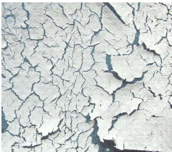
Obrázek 69 - „Vysychání“ nanovlákněné vrstvy oxidu křemičitého. Digitální fotoaparát, skutečná velikost.
