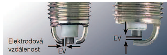
Obrázek 2.6: Označení elektrodové vzdálenosti u zapalovacích svíček s jednou a více vnějšími elektrodami. [47]
