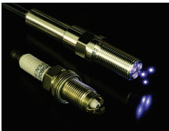
Obrázek 2.24: Porovnání klasické zapalovací svíčky se "svíčkou" laserovou. [11]
