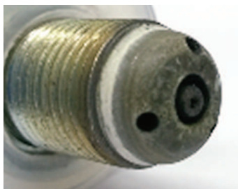
Obrázek 6.1: Pohled na poškozenou střední elektrodu ZSIK.
