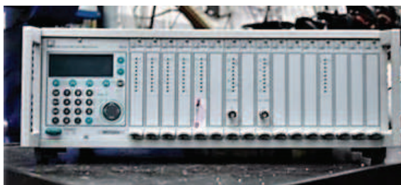
Obrázek 3.8: Měřicí ústředna MGCplus (od fy HBM) při experimentech používaná zejména k záznamu teplot pomocí termočlánků.
