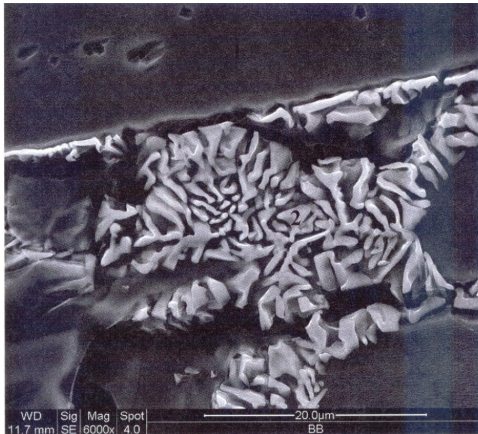
obrázek 14 – Lamelární agregát vyplňující mikrostaženiny v oceli ČSN 17 251
