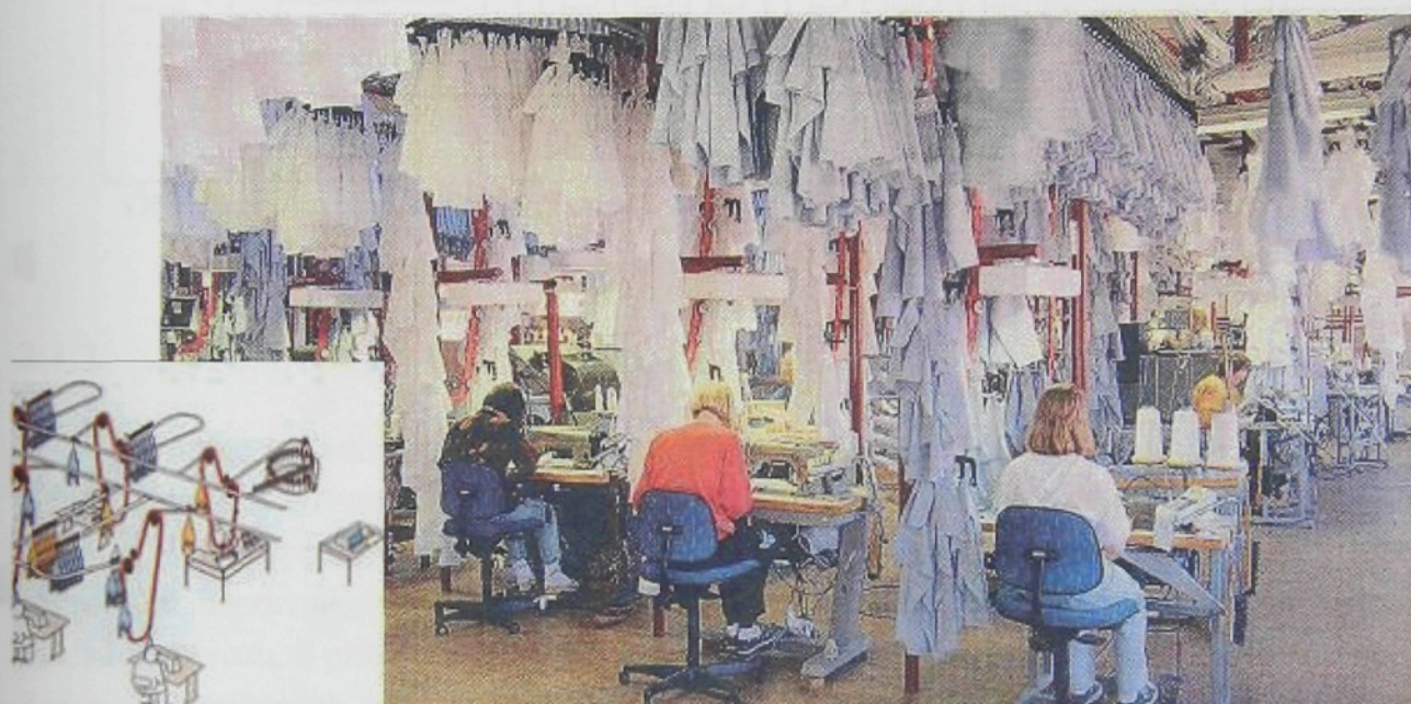
Obr. 3: Závěsný dopravníkový systém ETON pro oděvní výrobu
