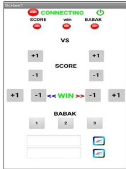
Gambar 7. Aplikasi telah connecting dengan Bluetooth HC-05 pada panel P10)
