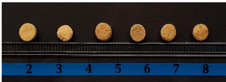
Slika 38 Fotografija irbesartan tablet dobijenih SLS štamptom. Tablete su štampane primenom različitih brzina lasera. Sa leva na desno: 100 mm/s, 120 mm/s, 140 mm/s, 160 mm/s, 180 mm/s, 220 mm/s
