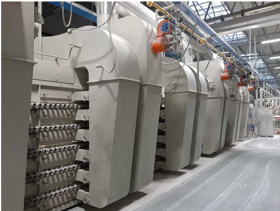
Obr. 22: Pětietážová válečková sušárna Zdroj: [11]
