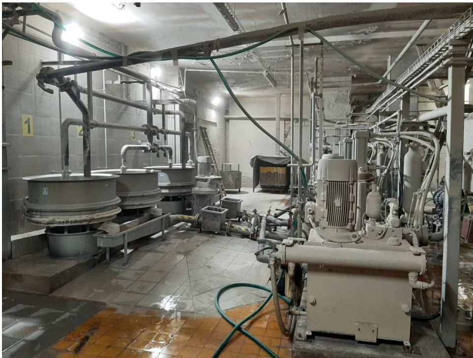
Obr. 18: Prostor pro míchání namletých surovin s vodou - vznik šliky Zdroj: [11]
