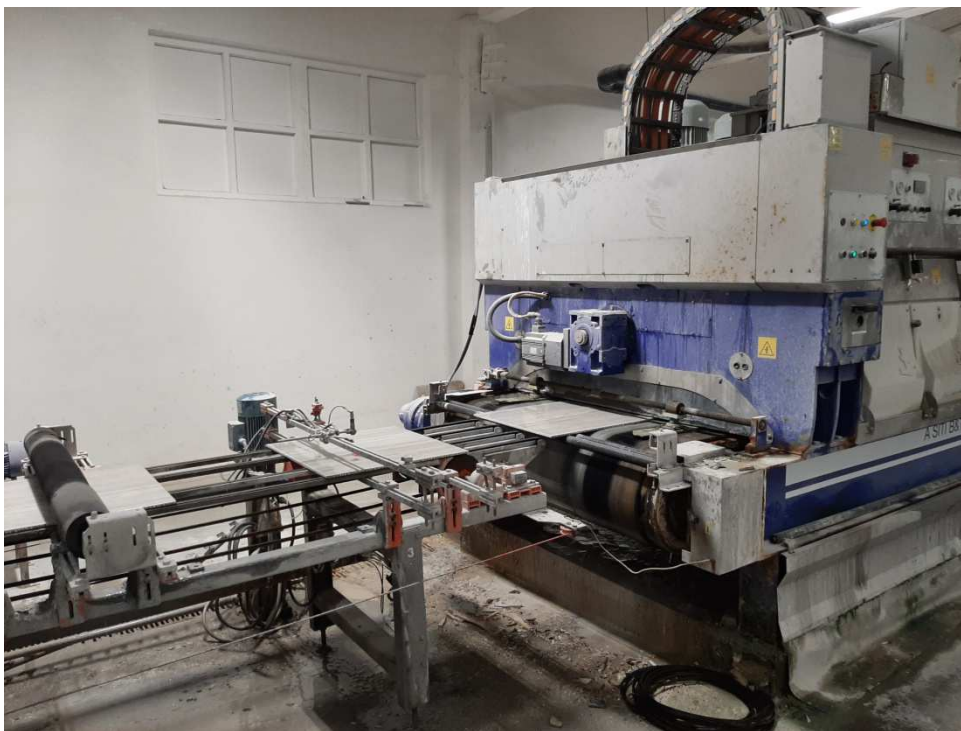
Obr. 25: Lapovací linka Zdroj: [11]
