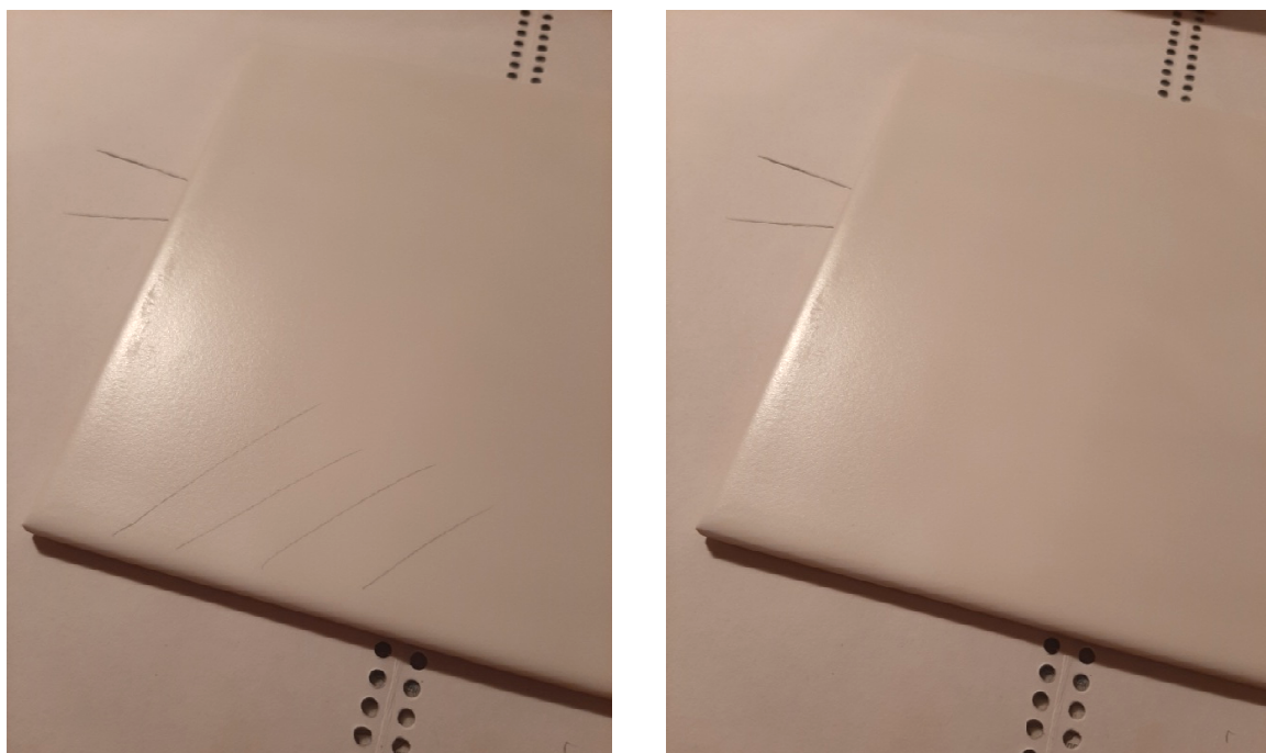
Obr. 50: Obkládačka před a po zkoušce tužkou - čáry se podařilo setřít
