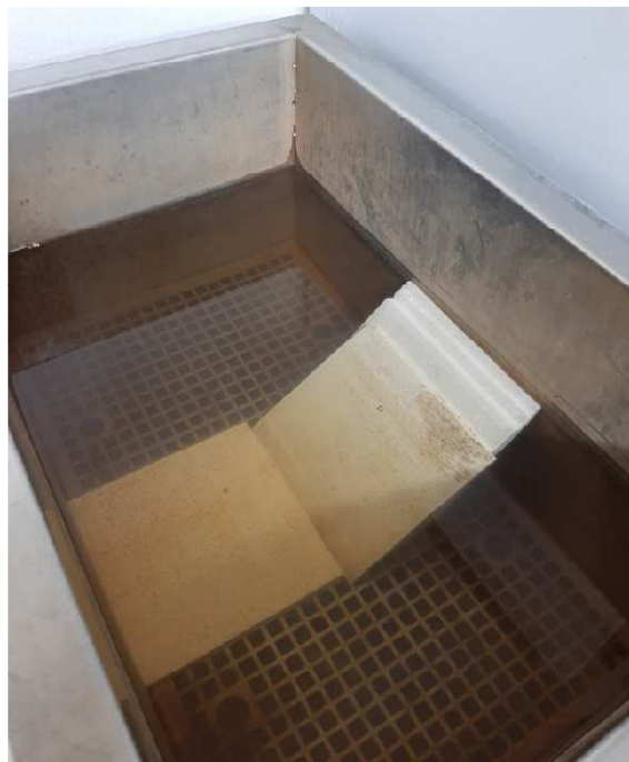
Obr. 48: Obkládačky ve varné vaně v průběhu vyndávání po varu
