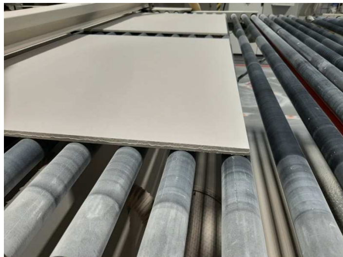
Obr. 20: Čerstvě vylisované prvky vyjíždějící po rolnách z lisu Zdroj: [11]
