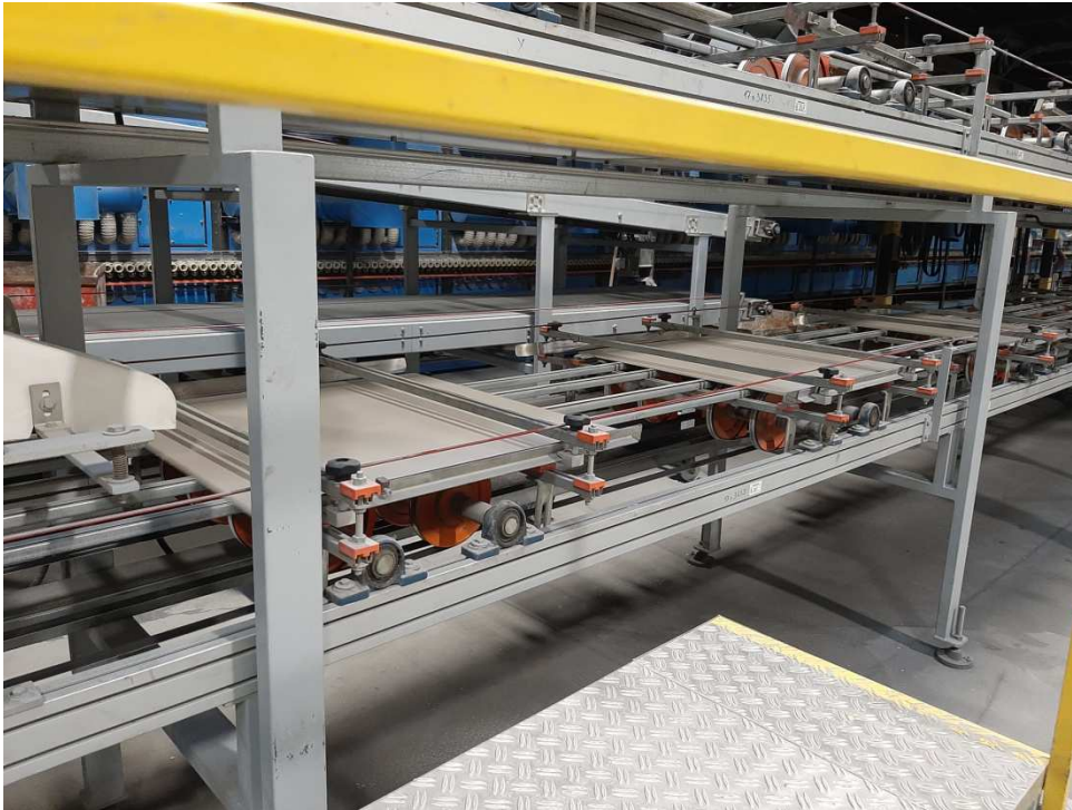
Obr. 24: Rolny pro přesun prvků do rolnové pece Zdroj: [11]
