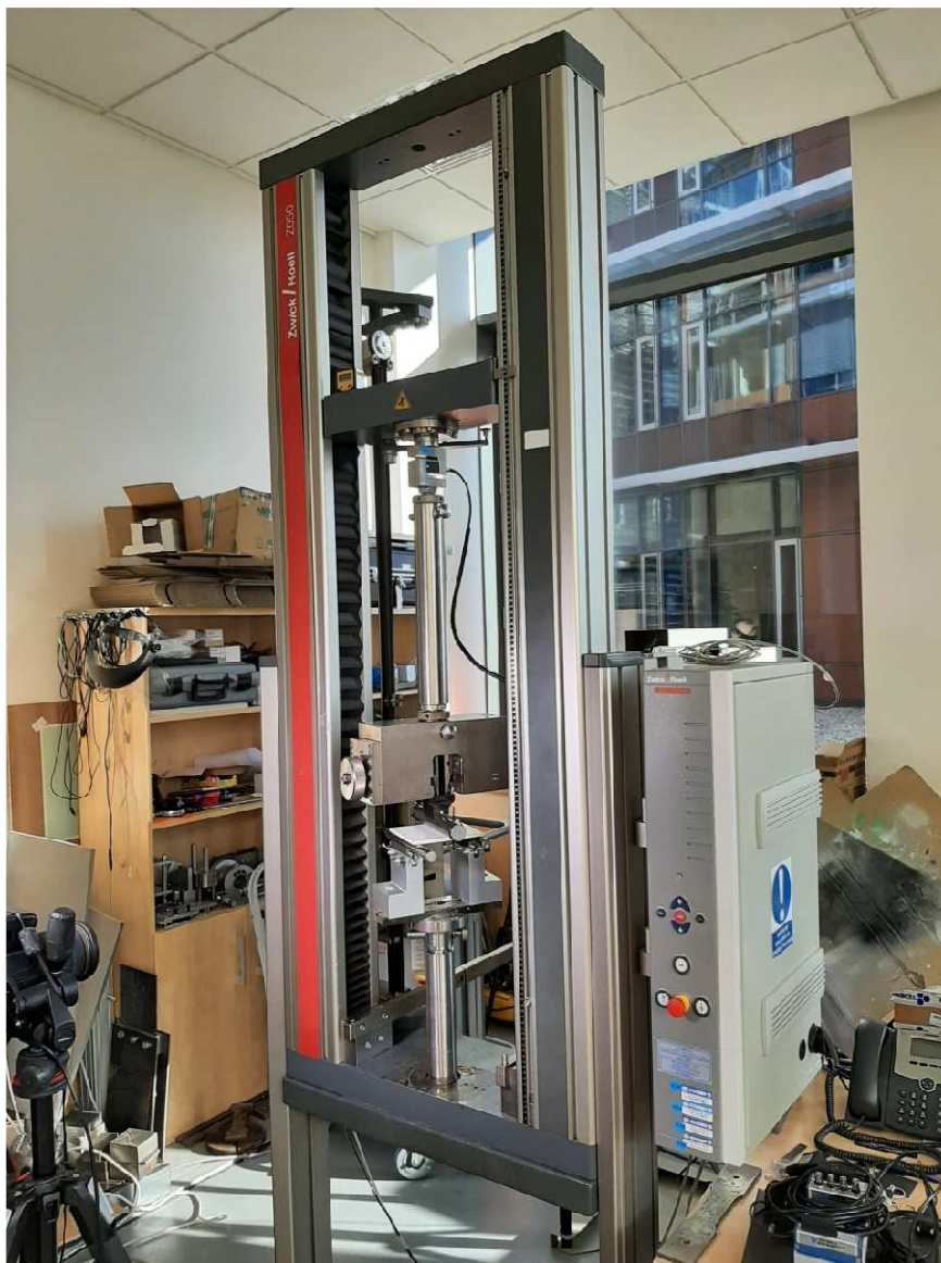
Obr. 43: Zatěžovací lis Zwick Roell Z050 v laboratoři NTIS
