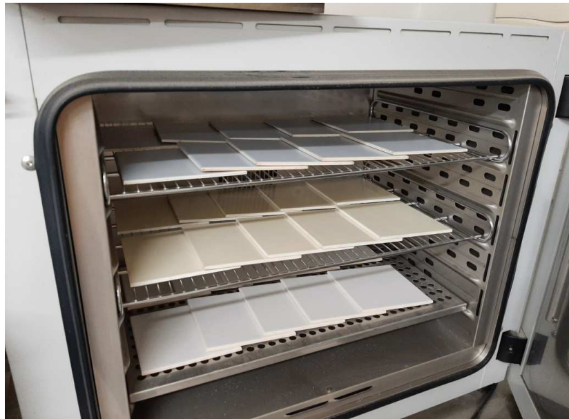
Obr. 47: Rozložení vzorků obkládaček v elektrické sušárně
