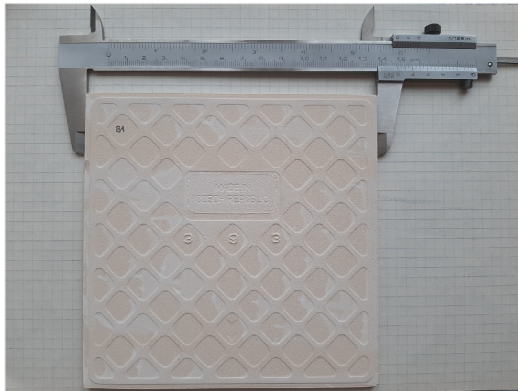
Obr. 46: Měření délky mechanickým posuvným měřítkem
