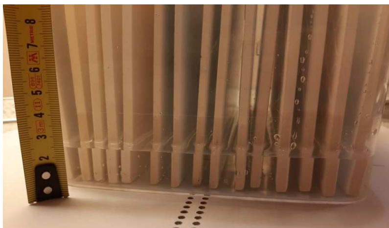
Obr. 49: Obkládačky vložené do zkušební roztoku o hloubce 25 mm
