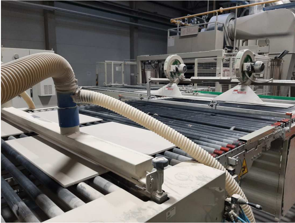
Obr. 21: Rolnová dráha pro přesun prvků do sušárny Zdroj: [11]
