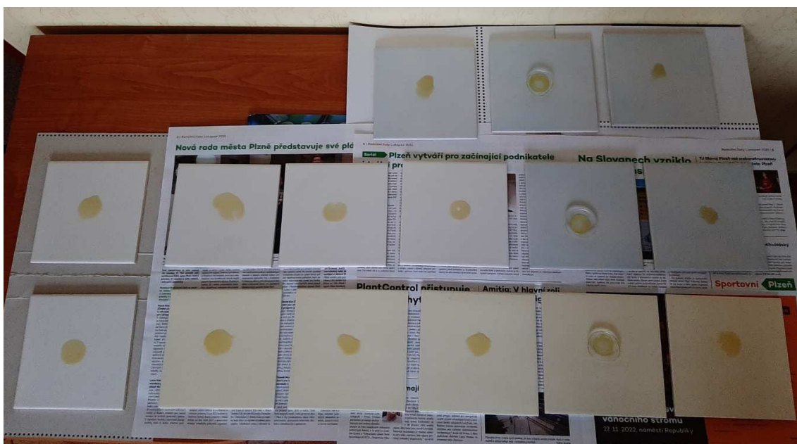
Obr. 51: Zkušební vzorky s naneseným olivovým olejem a sklíčky
