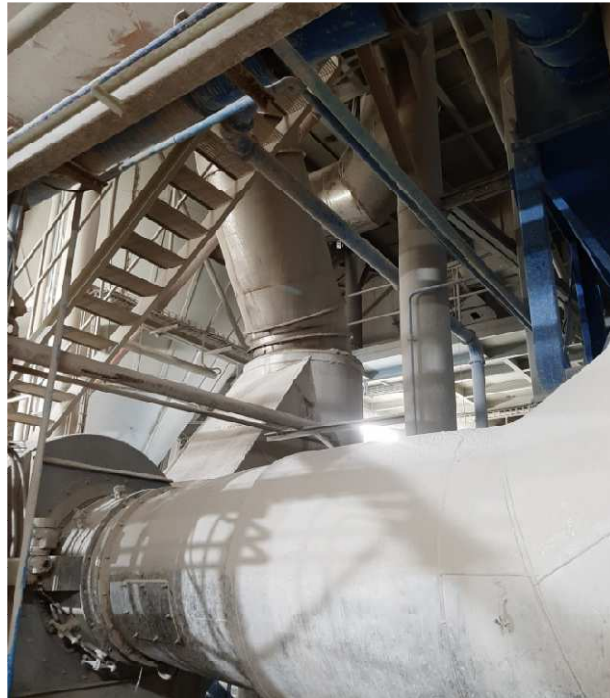
Obr. 19: Rozsprachovací věže pro sušení šliky Zdroj: [11]
