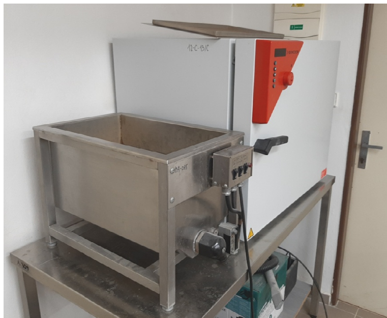
Obr. 37: Varná vana a elektrická sušárna BINDER Avantgarde.Line
