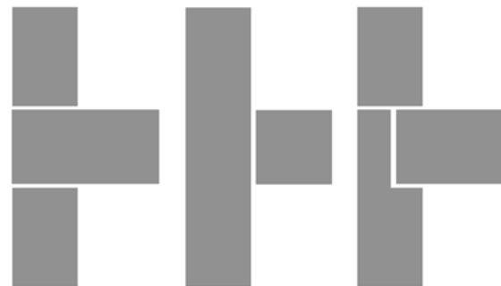
Fig. 11 – Van links naar rechts: Platformmethode, balloonmethode en de mengvorm
