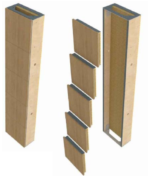
Fig. 40 – Gevelelement voor- en achtergevel
