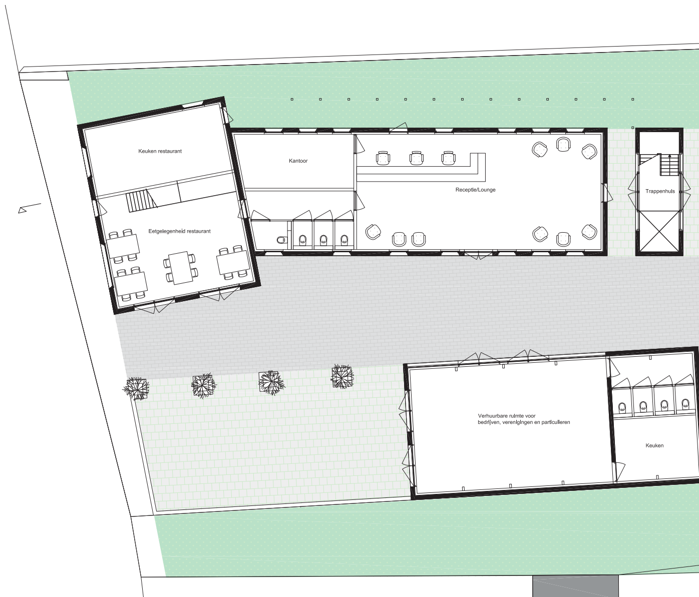
Figuur 5.10. Begane grond plattegrond 1:200 inclusief buitenruimtes
