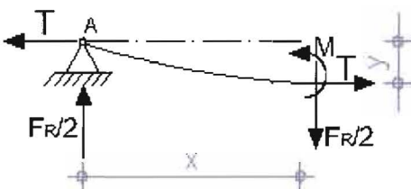
Figuur 4.11 Schematisatie snede van de trekbelaste staaf
