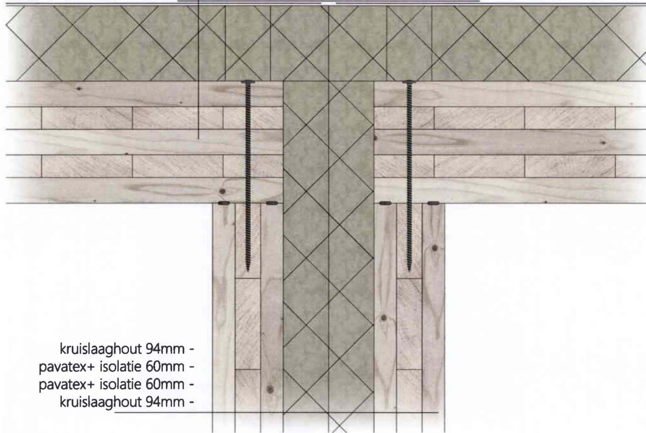
DETAIL 02 Verticale doorsnede Aansluiting wandelement - dakelement
