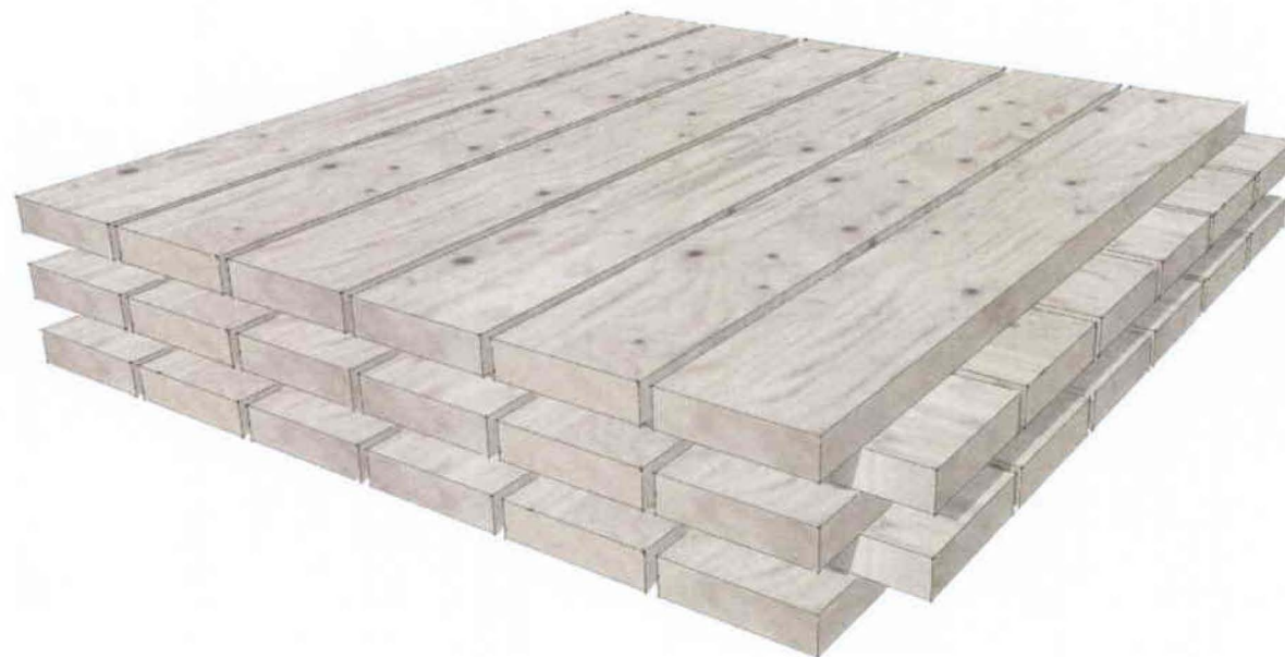
AFBEELDING 6.06 Kruislaaghout, verschillende planken worden onder 90° van elkaar verlijmd
