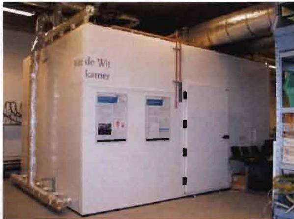
Figuur B1.1. Exterieur onderzoekskamer met de aansluitingen van het ventilatie- en verwarmingssysteem
