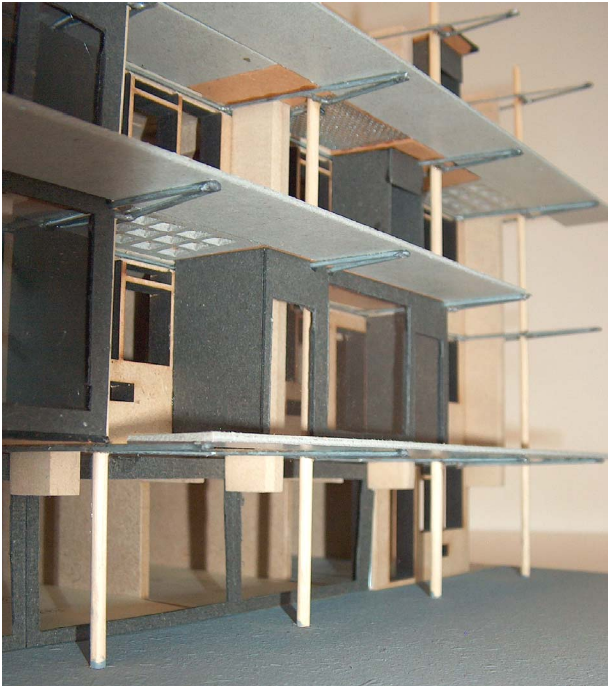
Fig. 39. De toegangsgevel met op de begane grond kantoren en een één-persoonswoning. Verder zijn te onderscheiden de tochtsluizen, de vloerroosters, de vloerdelen met glazenbouwstenen en de externe leidingschachten die aanvangen ter hoogte van het plafond op de begane grond.
