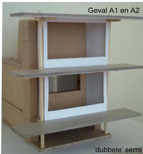
Fig. 52c. De verschillende gemeten situaties: 'dichte' situatie (D); met rooster of glazen bouwstenen (E); 'dubbele' serre (A1 en A2); 'lege' situatie (F1 en F2).
