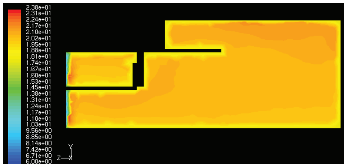
Figuur 38 De middels simulatie verkregen temperatuurverdeling over de dwarsdoorsnede van de kerk in de wintersituatie. Er is slechts een geringe stratificatie van enkele graden waarneembaar.
