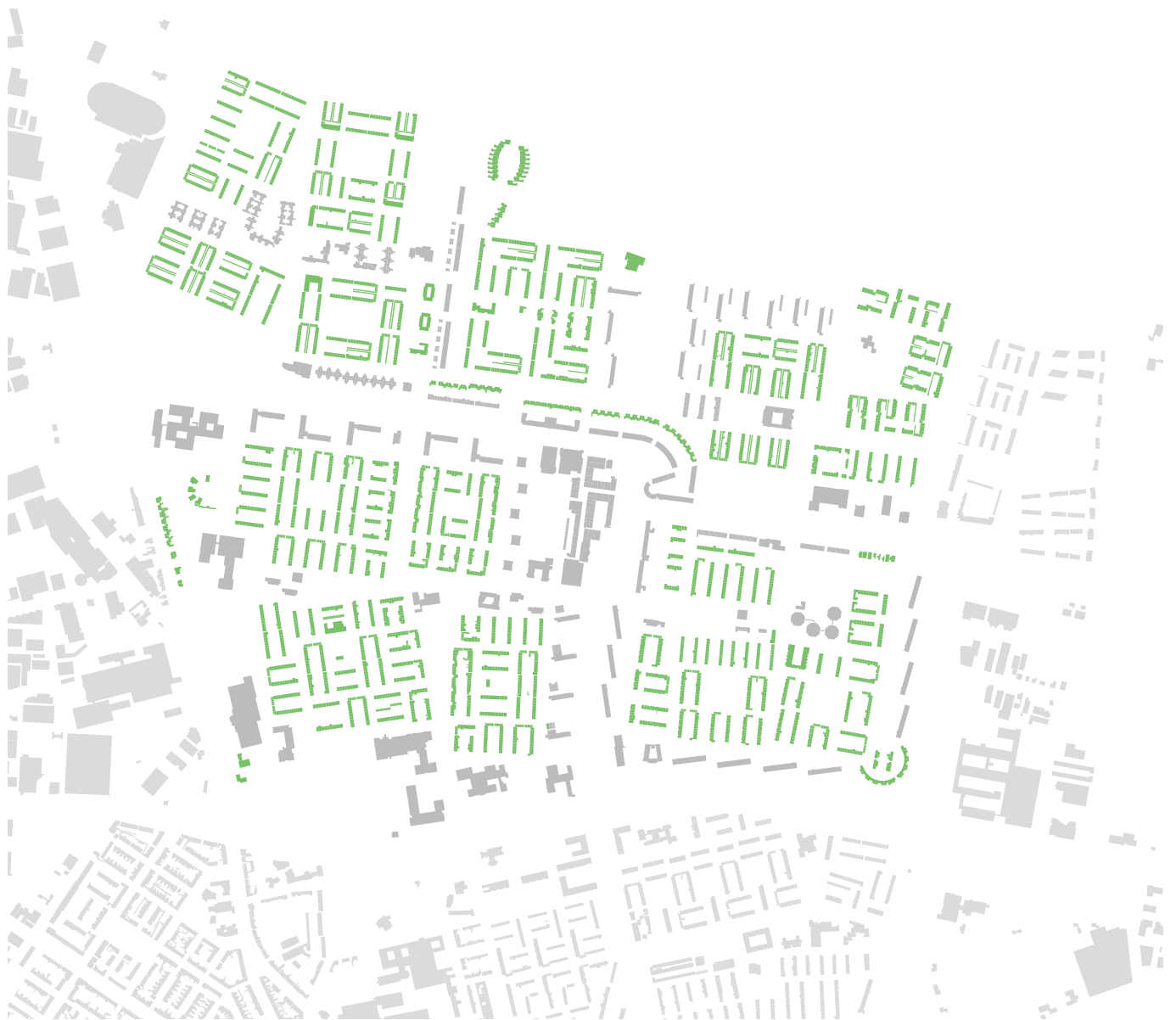
Afbeelding 3.7 Schuine daken waar zonnepanelen geplaatst kunnen worden
