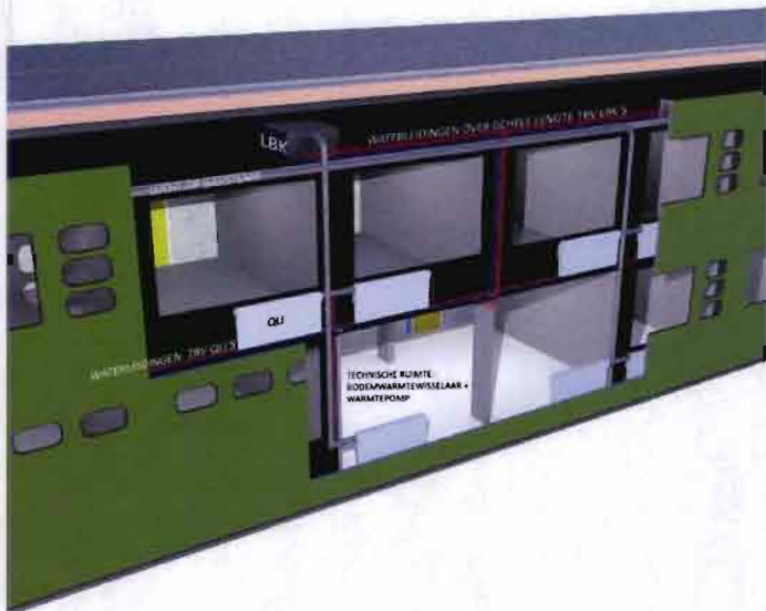
94 achtergevel opengewerkt - klimaatsysteem zichtbaar
