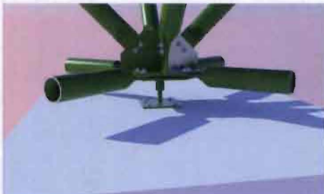
53 het plafond hangt aan vele knopen (dit principe behoud ik)
