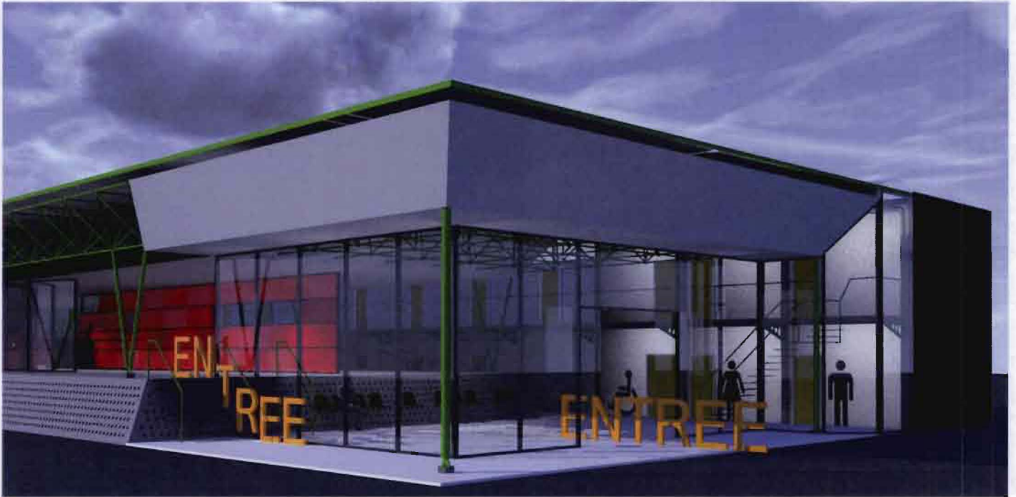
69 vloer niet doorgezet; entree op maaiveld leidt tot optimale toegankelijkheid
