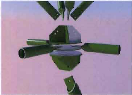
51 een isometrie van de knoop waarop de V-vormige kolom aansluit
