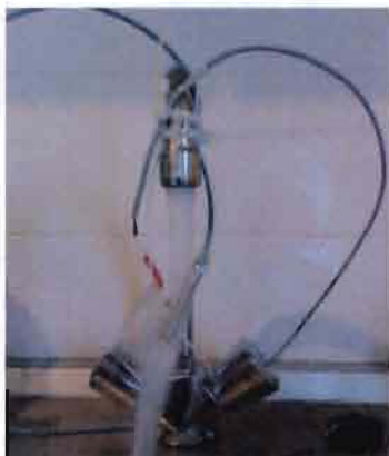
afbeelding 34: foto van de meetopstelling bij meting naar het temperatuurverloop bij tapwatervraag met en zonder comfortstand van de combiketel
