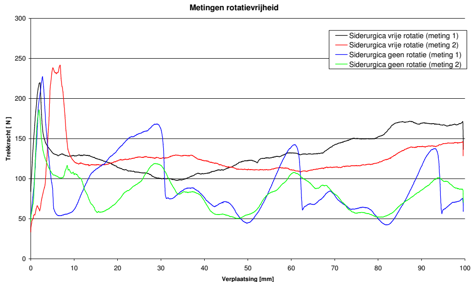
Figuur 7.16 Metingen trekkracht rotatievrijheid
