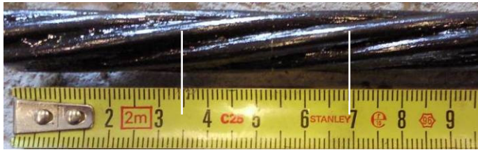
Figuur 6.18 Slaglengte Siderurgica voorspanstreng
