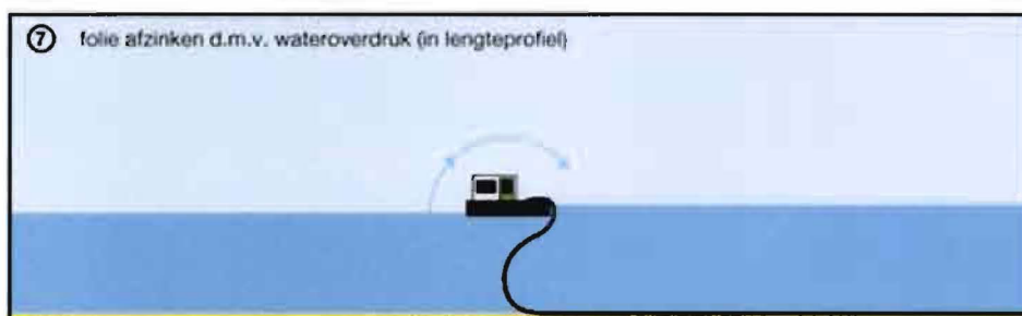
Afbeelding 2.4.2: het afzinken van een folie door middel van overdruk.
