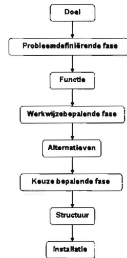
Figuur 89. Verschillende fasen van het ontwerpproces.
