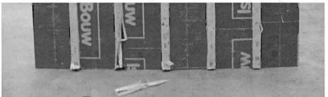
FIGUUR 5.5.4 ACHTERZIJDJE EN ONDERZIJDJE VAN WANDPANEEL 2 NA BEZWIJKEN
