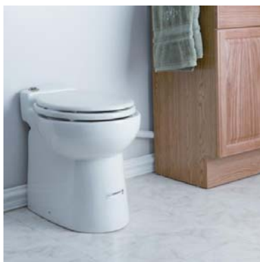
Figuur 94: Door gebruik te maken van een toiletsysteem met vuilwaterpompen en fecaliënvermalers kan de dimensie van de afvoer worden beperkt tot 32 mm. De systemen zijn demonteerbaar en verhoogd zodoende de flexibiliteit. 27
