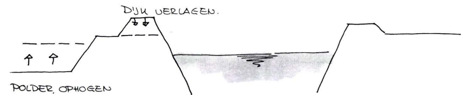
Fig. 4.27 relatie tussen de eilanden vergroten door dijk te verlagen en/of polder te verhogen
