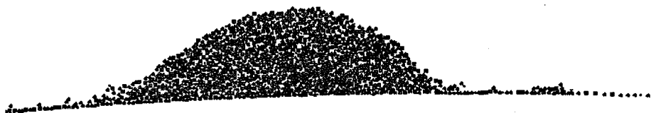
Figuur 6.6: Deze gesimuleerde tonerlijn lijkt goed op de metingen. Bij deze simulatie is gerekend met een gewijzigde stripmagneet en is slip uitgezet.
