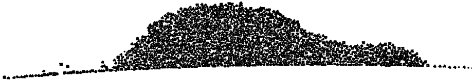
Figuur 6.7: Plaatje van een gesimuleerde tonerlijn op een stripmagneet waarin slip is uitgezet.
