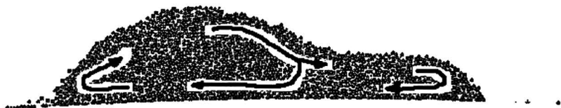
Figuur 4.2: Simulatie van een draaiende tonerlijn. De cylinder draait van rechts naar links. De toner draait rechtsom.
