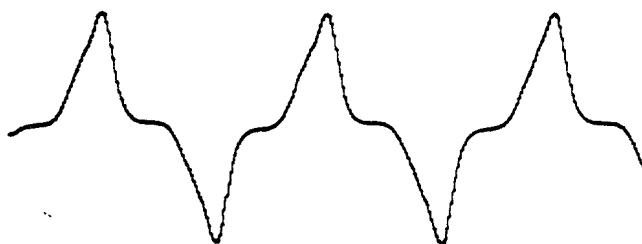
fig. 5.2 Uitgangssignaal van de krachtsensor
